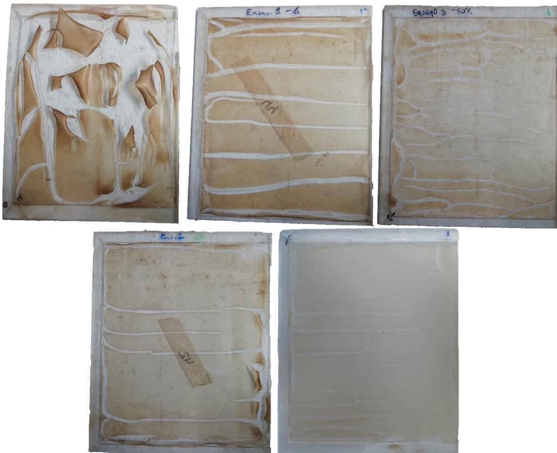
Figura 44. Aspecto de las películas con concentraciones 72,73/26,27, 70/30 y 65/35 de almidón-glicerina
