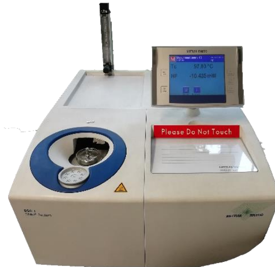
Figura 27. Mettler Toledo modelo DSC 1
