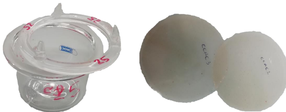
Figura 33. Vaso usado para análisis WVP al a izquierda. Obleas de los films a la derecha
