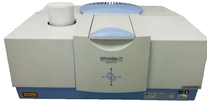
Figura 21. Espectrómetro IR Prestige-21 FTIR, Shimadzu
