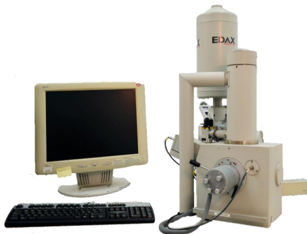
Figura 23. Microscopio electrónico de Barrido, FEI Quanta 200
