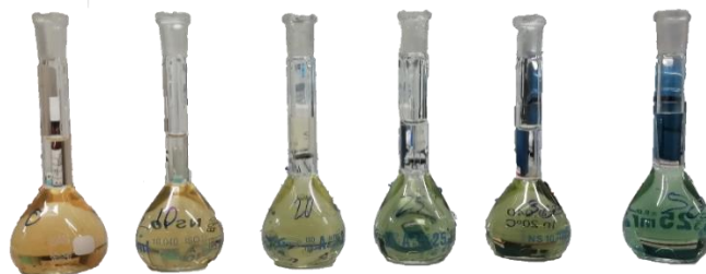
Figura 20. Soluciones de amilosa con Lugol en diferentes concentraciones según la norma para la curva de calibración
