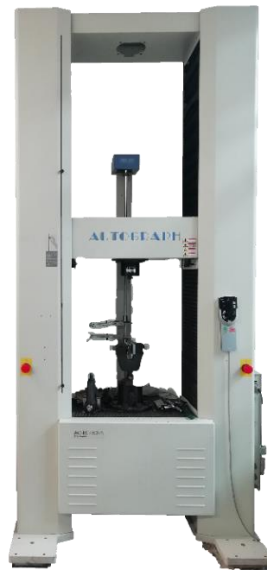
Figura 32. Máquina universal de tracción AG-IS Shimadzu
