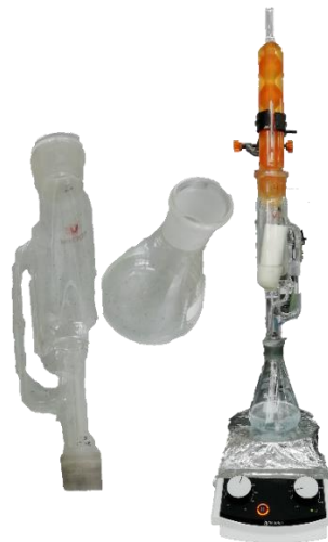
Figura 18. Equipo Soxhlet usado para el desgrasado
