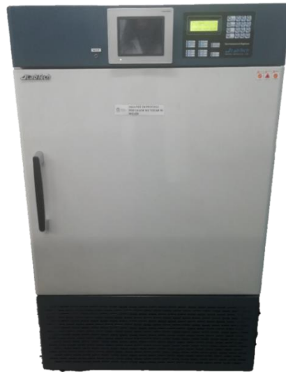
Figura 34. Cámara de intemperismo de la marca LabTech modelo LHT0150E
