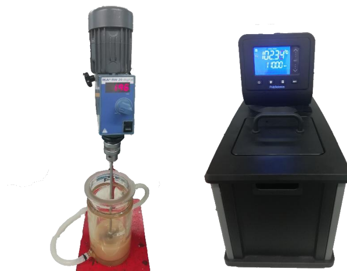
Figura 31. A la izquierda el agitador de cabeza de IKA modelo RW20 digital. A la derecha el baño termostático de PolyScience
