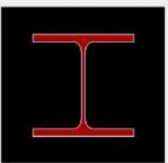
Sección: Tipo de sección: HEB 260
