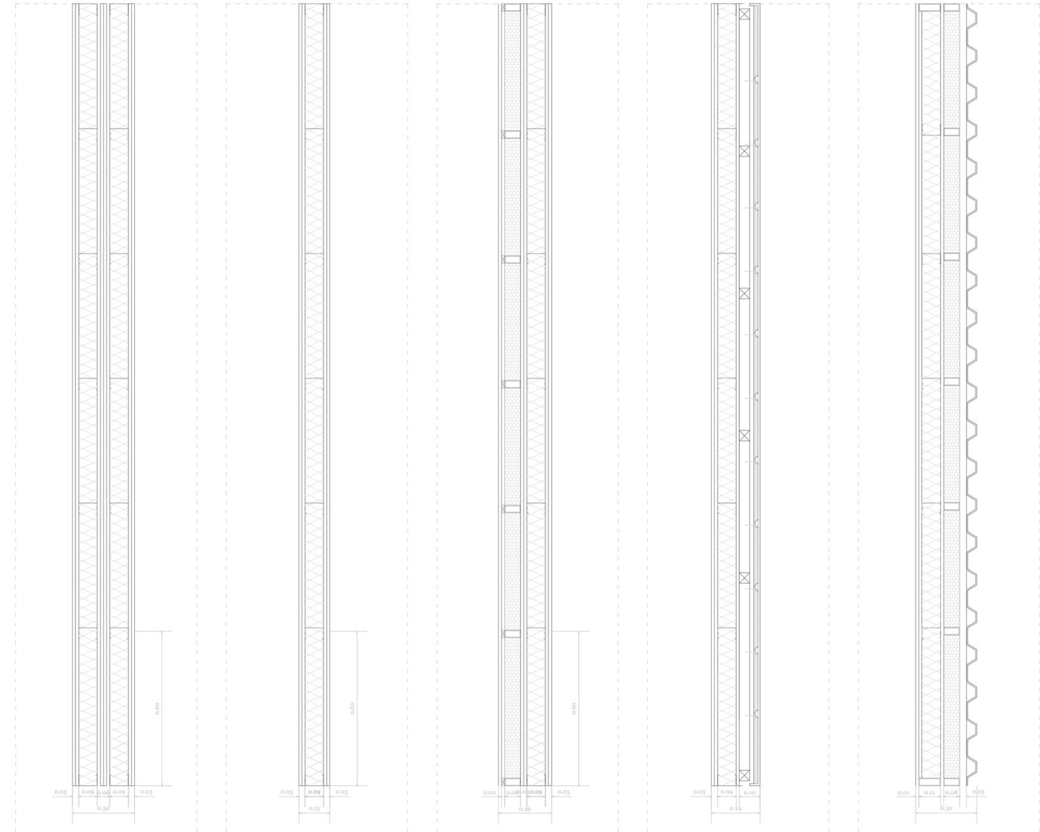
Detalles tipo de las particiones y envolventes que conforman el conjunto. De izquierda a derecha: Sistema de partición para medianeras, sistema de partición simple interior, envolvente de chapa de madera, envolvente de GRC, envolvente de chapa grecada de acero galvanizado.
