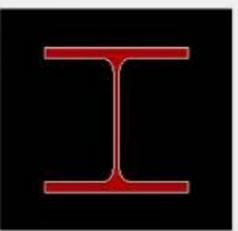
Sección: Tipo de sección: HEB 260
