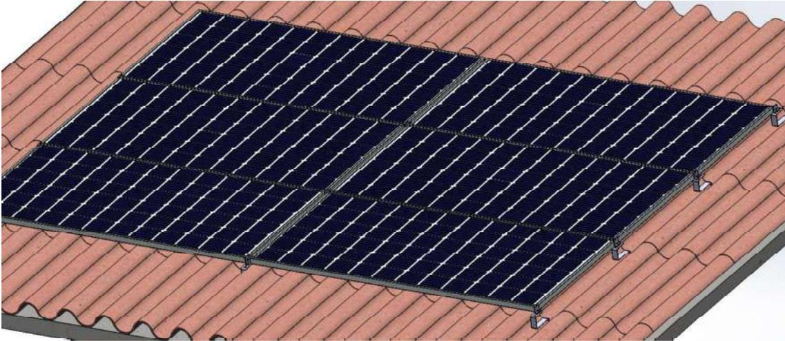
Figura 41: Anclaje Placas solares cubierta teja cerámica
