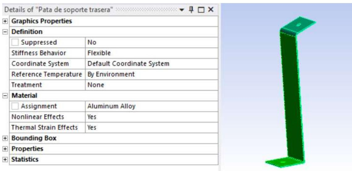
Figura 10: Asignación material pata de soporte trasera
