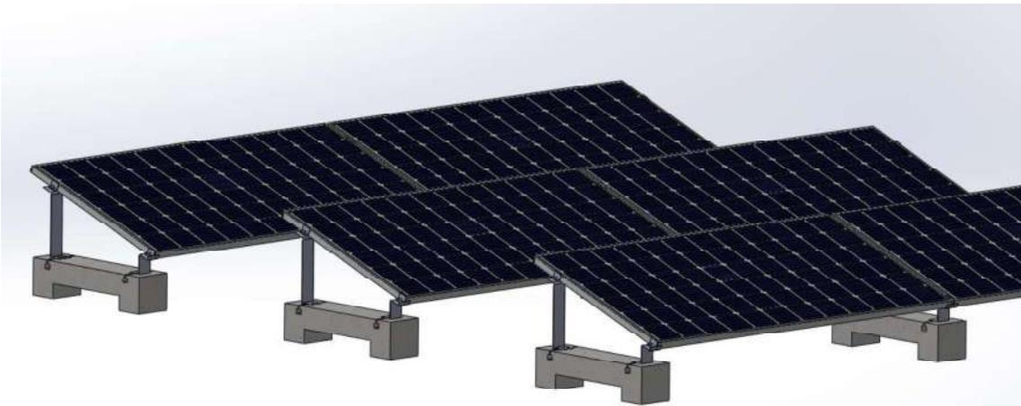
Figura 43: Anclaje placas solares a lastre de hormigón
