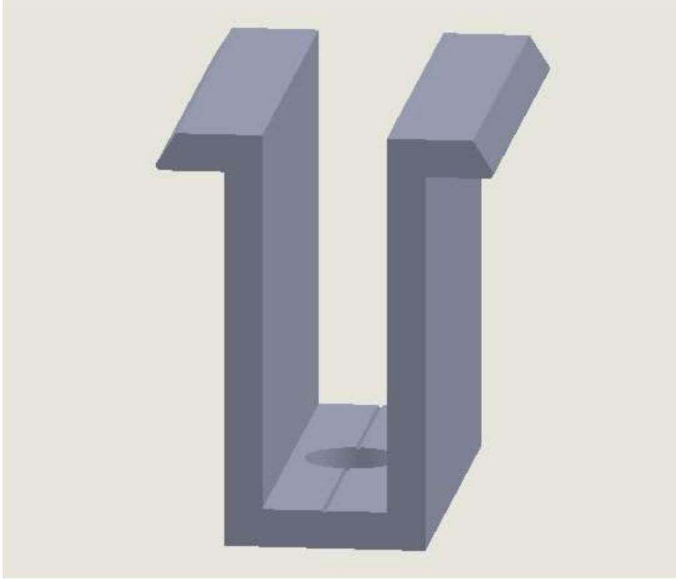
Figura 20: Diseño pinza intermedia
