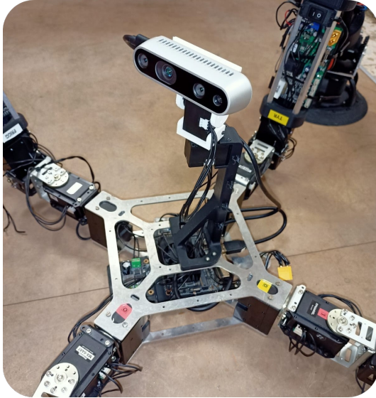
Figura 4: Cuerpo que aloja 4 módulos y todos los componentes necesarios para el compute.
