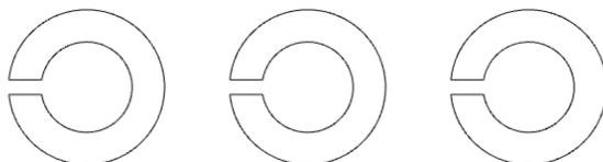
Figura 23: Dispersores con un resonador de Helmholtz su interior, estando este diseñado para una  $f_h$  de 250 Hz
