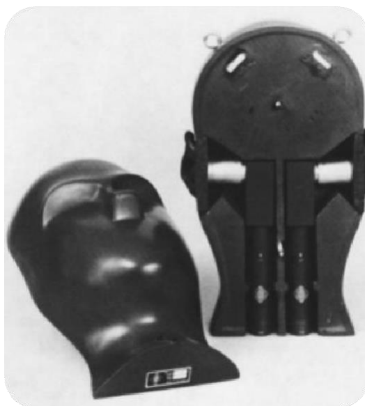
Figura 5: Prototipo de cabeza de maniquí acústico, o "Dummy". Fuente: Gotham Audio Corporation
