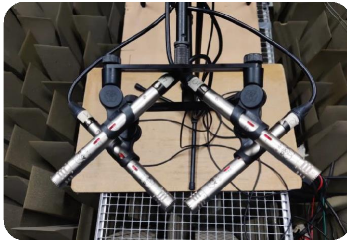
Figura 29: Configuración de los pares estéreo en X-Y y ORTF
