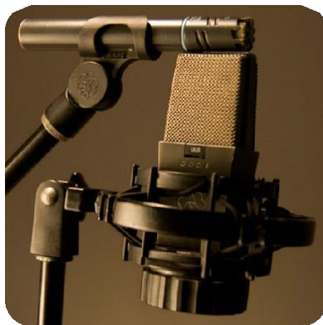
Figura 12: Ejemplo de dos micrófonos configurados como M-S. Fuente: https://music.tutsplus.com
