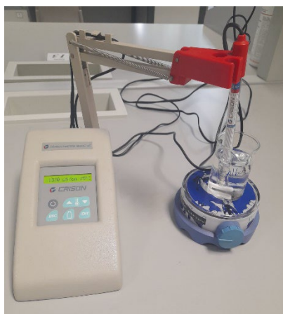
Figura 16. Medida de la conductividad de una de las muestras de agua.
