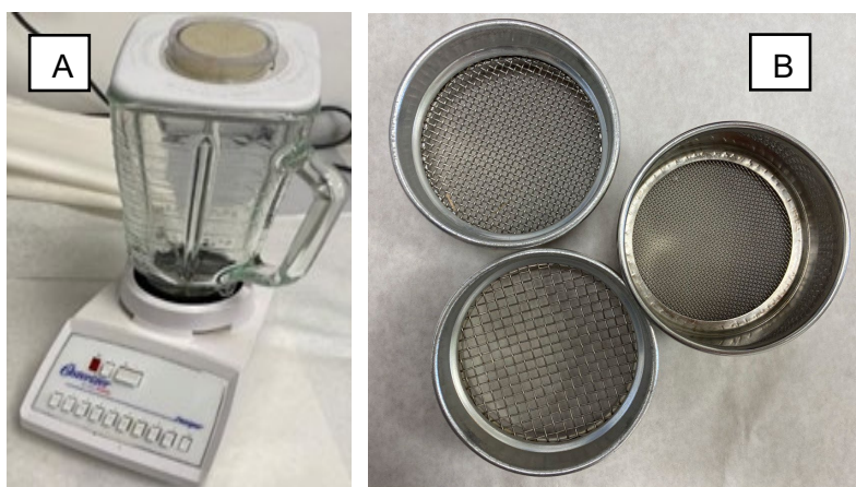
Figura 20. A. Batidora utilizada para la trituración del plástico; B. Tamices utilizados para seleccionar los pedazos con tamaño de microplásticos.
