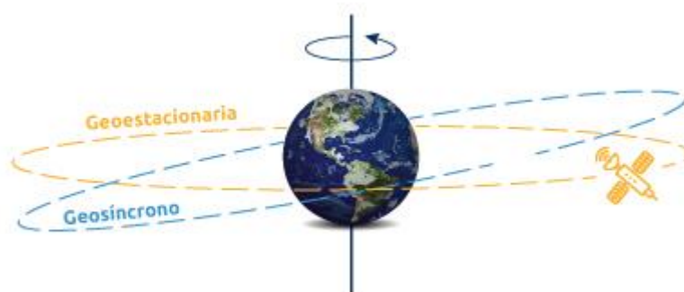
Figura 4: Comparativa de órbita geoestacionaria y geosíncrona.
