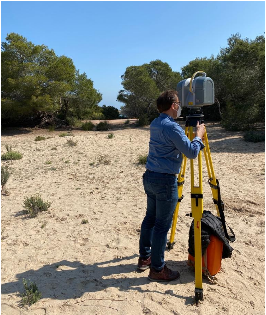
Figura X. Fernando Buchon escaneando una parte de El Saler en Valencia con una estación LiDAR Leica. Fotografía de Dolores Furió 2021.
