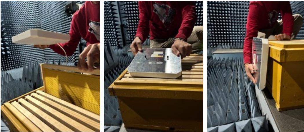
**Figura 5.3: Evaluación en el interior de la cámara anecoica de la UPV del comportamiento del primer prototipo de antena desarrollado.**
