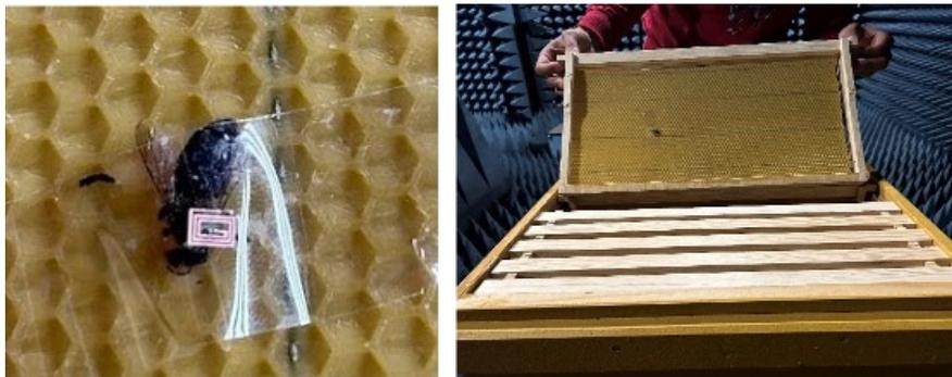
**Figura 5.4: Imágenes del primer prototipo de antena colocado sobre la abeja y pegado al panel de cera con cinta adhesiva.**
