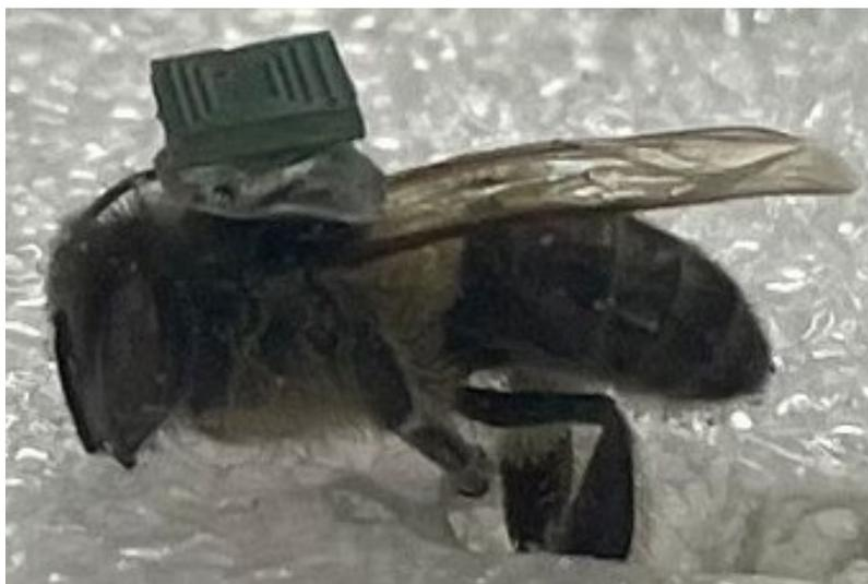
**Figura 7.9: Integración del diseño de *tag* definitivo sobre una abeja reina.**
