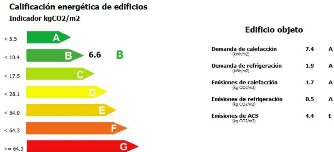
Figura 25. Calificación energética de la vivienda llevando a cabo el aislamiento térmico de la cubierta, la fachada y el forjado entre la planta baja y el sótano. Fuente: Captura propia CE3X.
