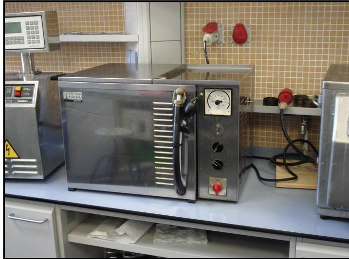
*Fig.3.7. Linitest, realización lavados*
