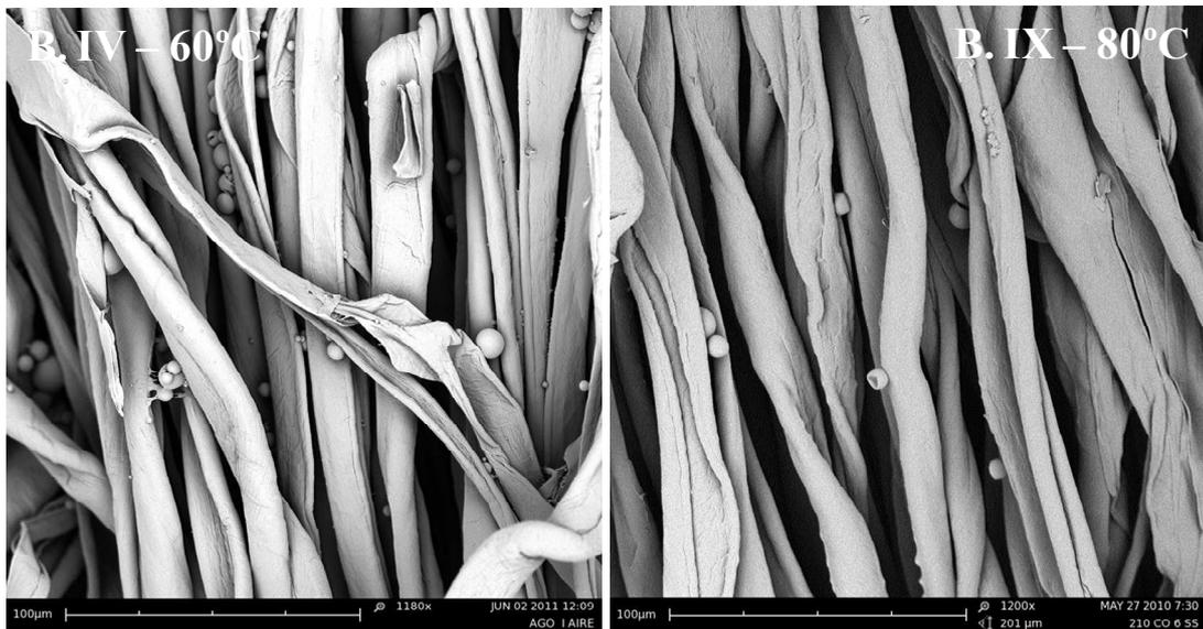
***Fig. 4.3.9. Micrografías estudio comparativo influencia de la temperatura, Baño IV y Baño IX (6% s.p.f. producto microencapsulado y 1% s.p.f. resina acrílica). Las micrografías están realizadas a 1180 y 1200 aumentos***
