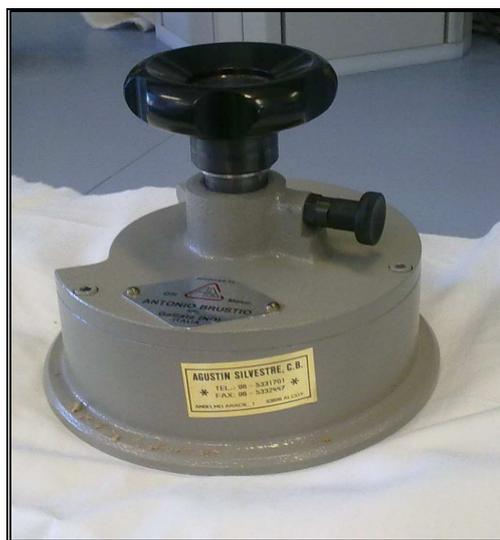
*Fig.3.9. Cortador probetas, determinación del gramaje*
