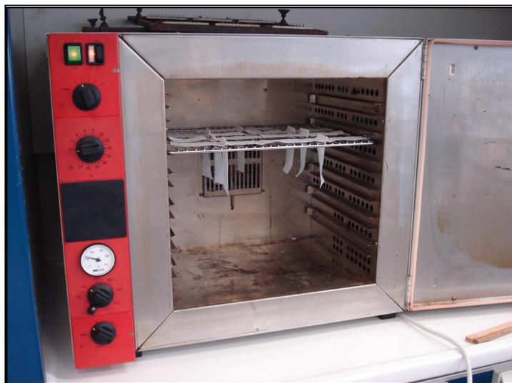
*Fig.3.8. Estufa aire forzado, ensayos resistencia al lavado*
