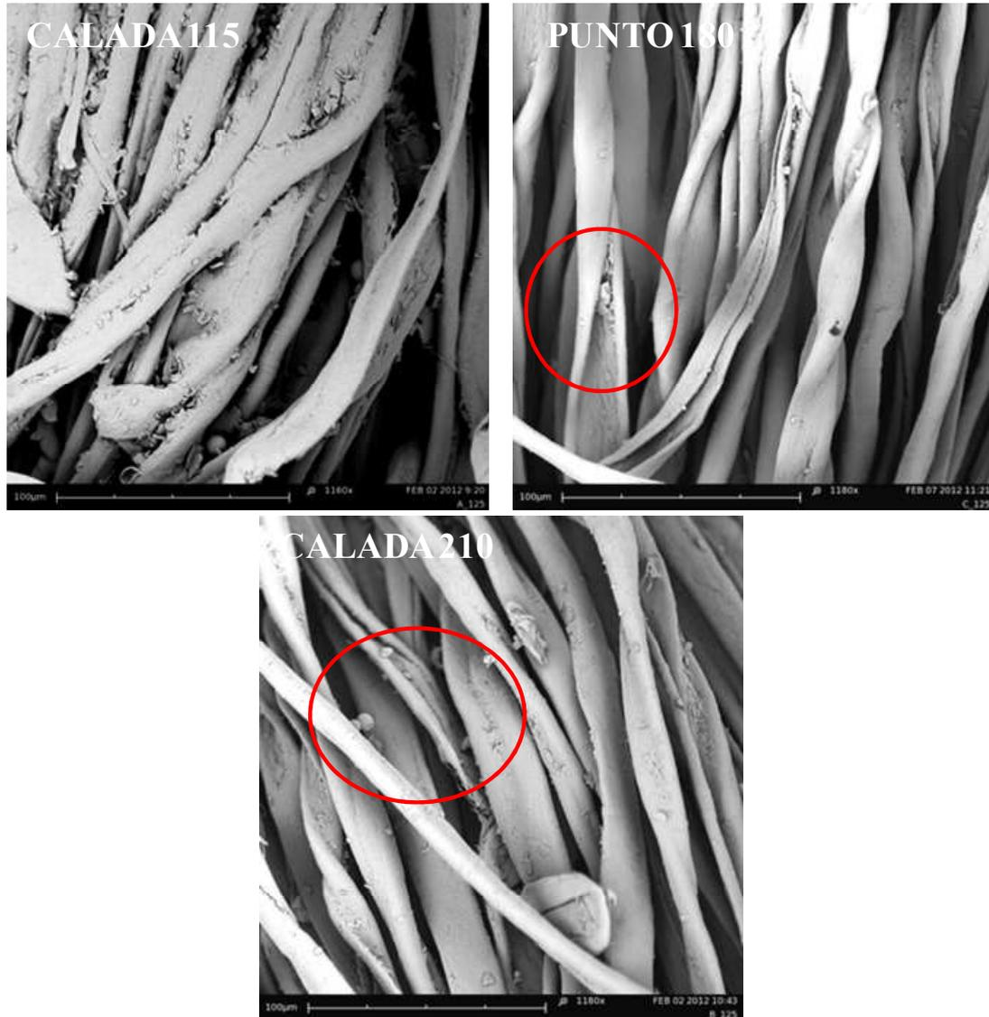
**Fig.4.2.34. Influencia de la abrasión en la permanencia de las microcápsulas, 125 ciclos. Las micrografías están realizadas a 1160 y 1180 aumentos**
