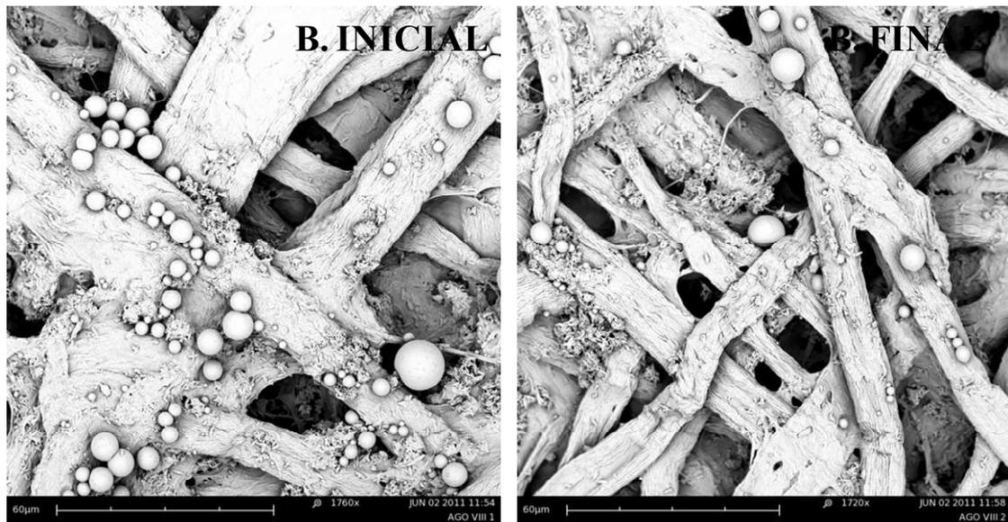
**Fig. 4.3.7. Micrografías estado del Baño X (12% s.p.f. producto microencapsulado y 2% s.p.f. resina acrílica) antes y después aplicación a 80°C. Las micrografías están realizadas a 1760 y 1720 aumentos**
