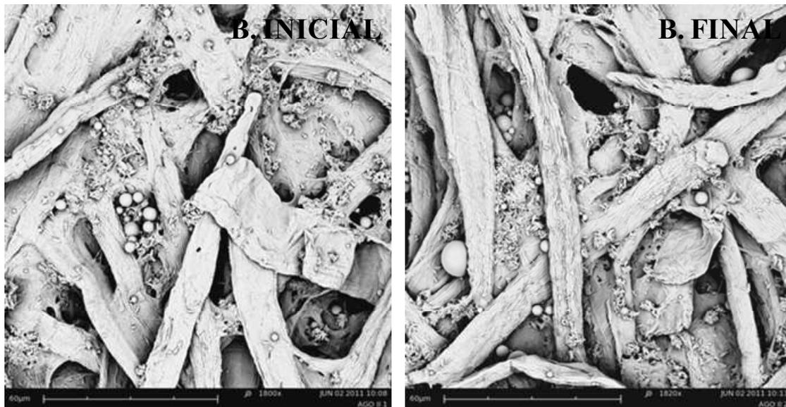
**Fig. 4.3.4. Micrografías estado del Baño V (12% s.p.f. producto microencapsulado y 2% s.p.f. resina acrílica) antes y después aplicación a 60°C. Las micrografías están realizadas a 1800 y 1820 aumentos**
