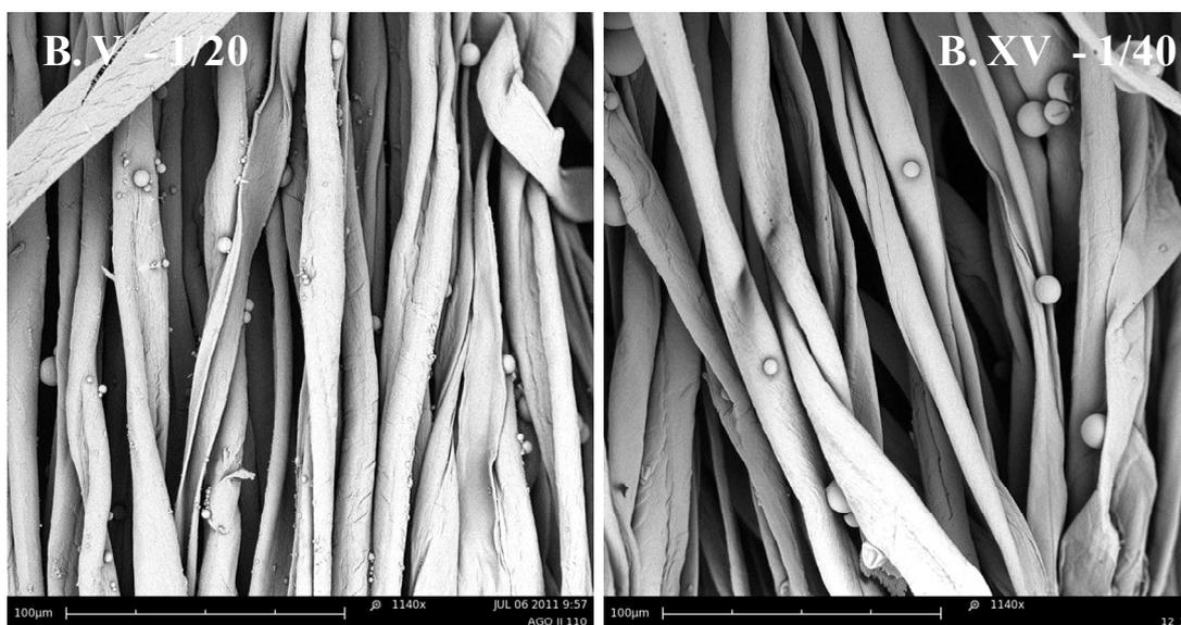
**Fig. 4.3.20. Micrografías estudio comparativo influencia de la relación de baño, Baño V y Baño XV (12% s.p.f. producto microencapsulado y 2% s.p.f. resina acrílica). Las micrografías están realizadas a 1140 aumentos**
