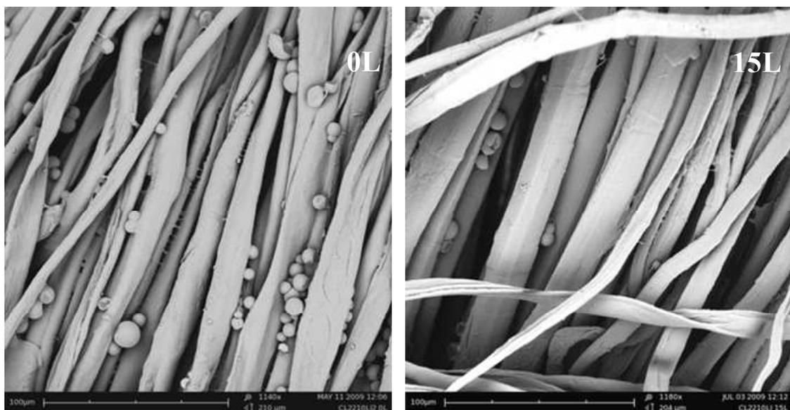
**Fig.4.2.17. Influencia del lavado en la permanencia de las microcápsulas, tejido de algodón-lino, Co-Li. Las micrografías están realizadas a 1140 y 1180 aumentos**
