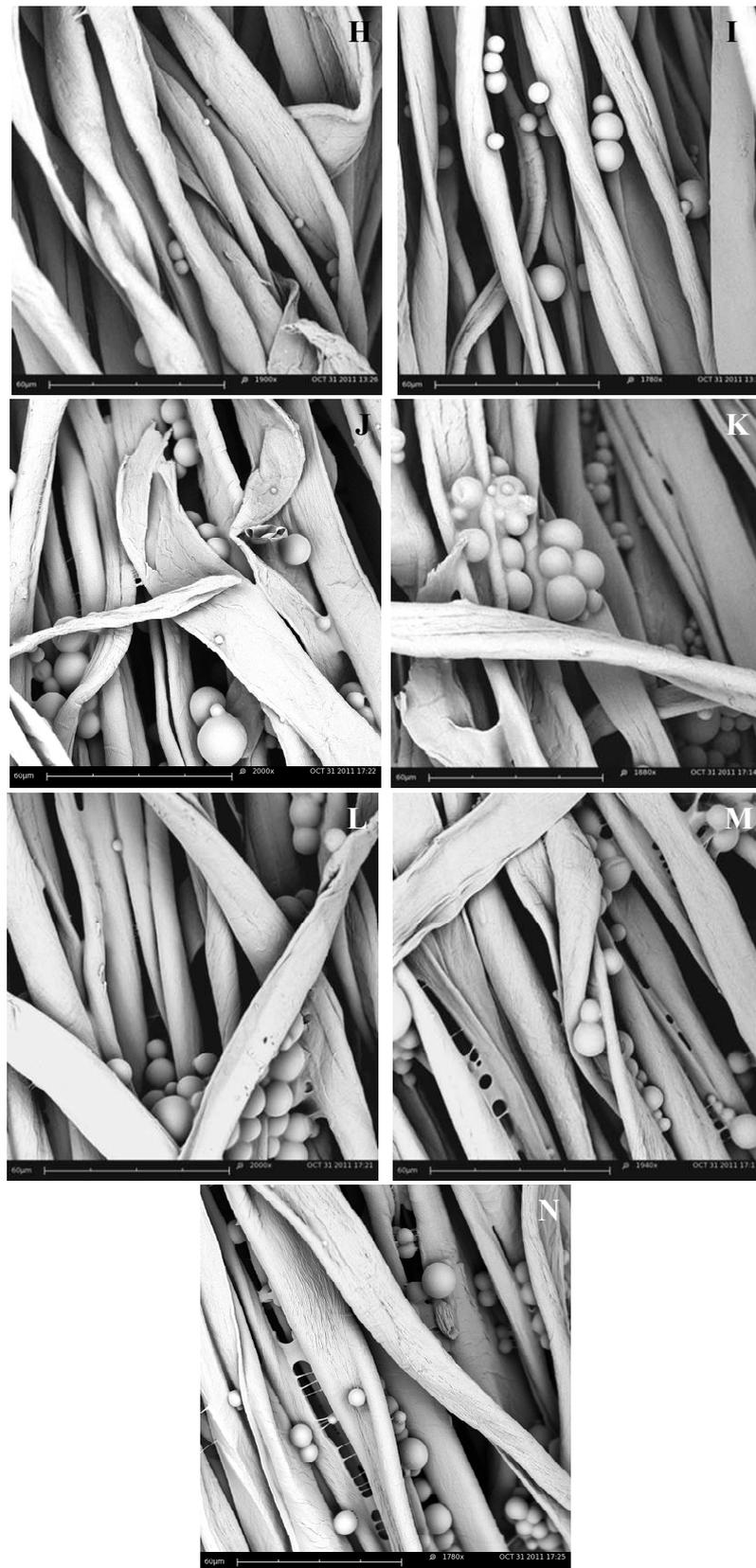
**Fig.4.3.22. Microfotografías tejido de algodón de 210 g/m<sup>2</sup> impregnados con Baños H hasta N. Las microfografías están realizadas a 1800 y 2000 aumentos**
