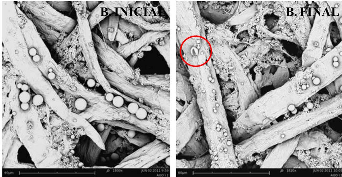
**Fig. 4.3.3.** Micrografías estado del Baño IV (6% s.p.f. producto microencapsulado y 1% s.p.f. resina acrílica) antes y después aplicación a 60°C.
