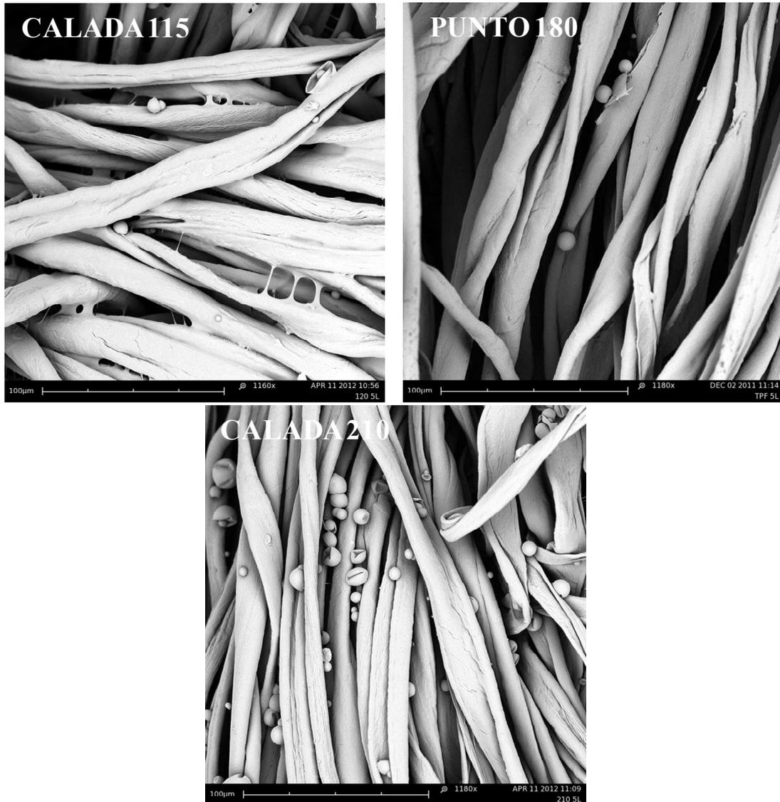
**Fig.4.2.33. Influencia del lavado en la permanencia de las microcápsulas, 5 ciclos de lavado. Las micrografías están realizadas a 1160 y 1180 aumentos**
