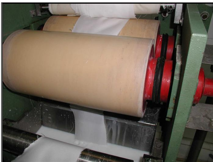
*Fig.3.3. Fulard horizontal empleado en la aplicación por impregnación*
