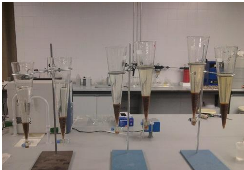
Figura 11. Resultado del tratamiento con FeCl 3 y Quifloc para diferentes concentraciones de FeCl 3 (de izquierda a derecha la concentración va incrementándose).
