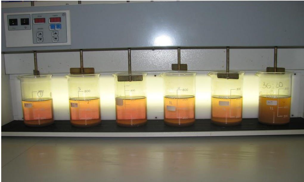
Figura 15. Prueba “jar-test” a diferentes pH de tratamiento con 0,75 ml/L de Ecomix en todos los vasos (de derecha a izquierda pH de: 5,09, 6,03, 6,93, 8,5, 8,78 y 8,48).
