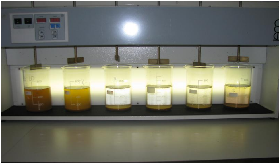
Figura 14. Prueba “jar-test” a diferentes pH de tratamiento con 0,5 ml/L de FeCl_3 en todos los vasos (de derecha a izquierda pH de: 9,01, 8,22, 7,02, 6,1, 4,94 y 4,32).
