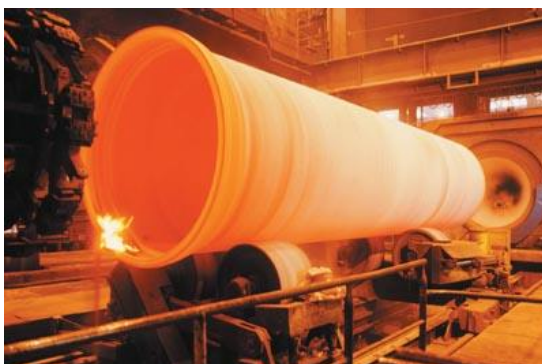
Figura 8. Proceso de fundición para una tubería de gran diámetro
