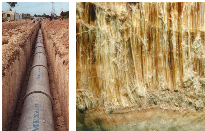
Figura 10. Tubería de fibrocemento utilizada en red de alcantarillado (izquierda). Refuerzos de fibra de amianto (derecha)
