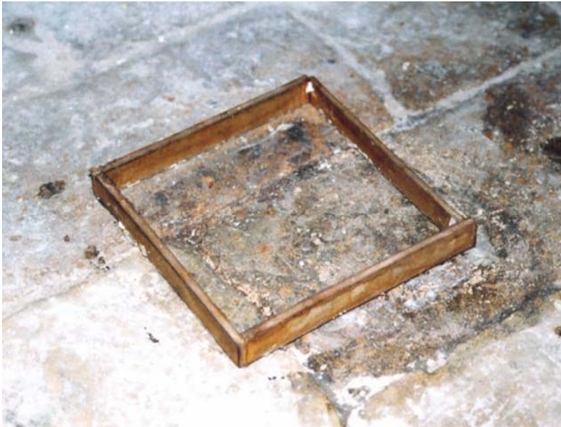
Tabique de cartón que se realizó para reproducir la textura del suelo de adoquines en la prueba número siete.
