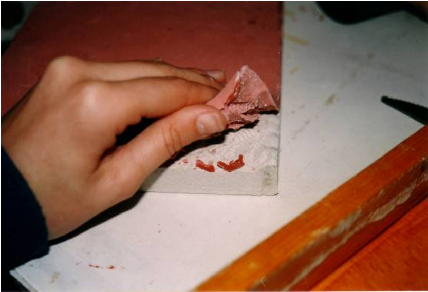
Separación de la escayola y la plastilina. La plastilina se separa de la escayola intentando que no queden restos sobre esta.
