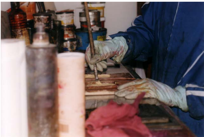
Aplicación de la tinta a una matriz de resina de poliuretano rígido mediante una brocha de cerda. Este método es muy práctico ya que con la brocha introducimos la tinta en todos los huecos más escondidos de la matriz de manera rápida y además permite economizar la tinta.
