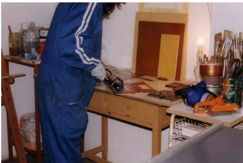
Entintado del relieve de una matriz de resina mediante un rodillo de goma de 20 cm. de la marca Artools para calcografía.
