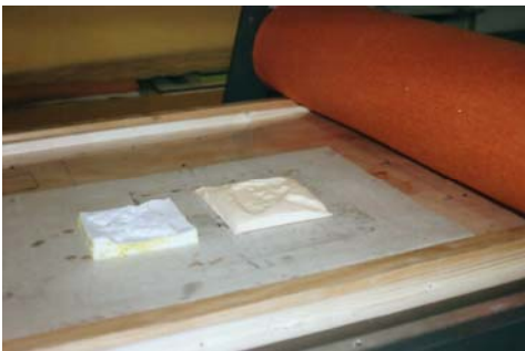
Matriz con la pulpa de papel colocada encima junto al contramolde de silicona, listos para ser estampados
