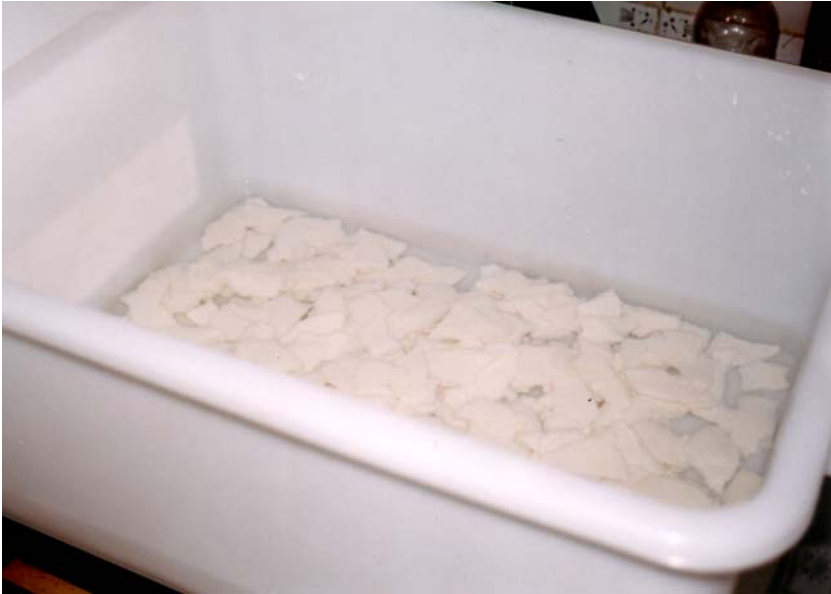
Pasta de papel seca que se ha troceado y se ha puesto ha remojo para ser batida posteriormente.
