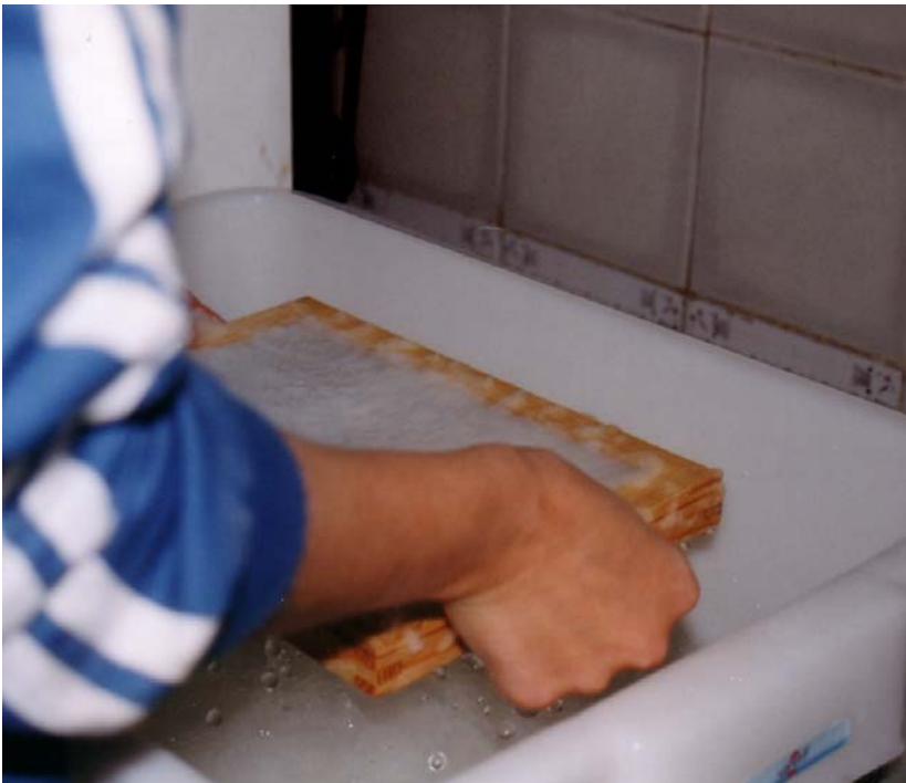
Formación de la hoja manualmente mediante la inmersión del molde con el marco en la cubeta con pulpa de papel y agua. El molde se sumerge y se levanta realizando un pequeño movimiento para que las fibras de papel se entrelacen entre ellas para consolidar la hoja de papel.
