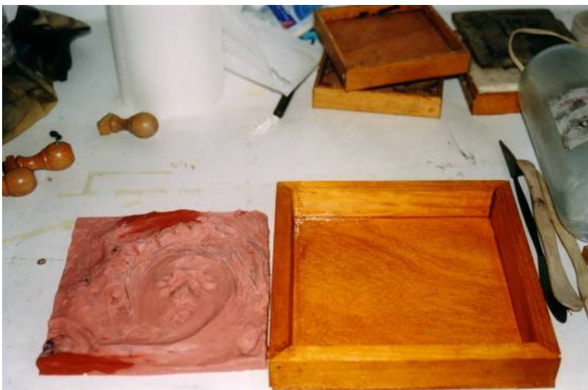
Muestra de la caja de madera junto al original de plastilina para reproducir.
