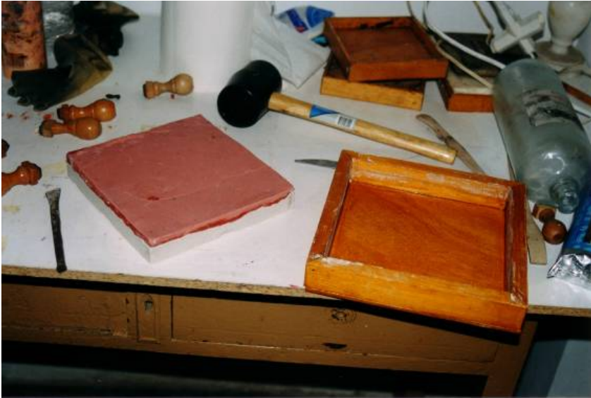
Extracción de la pieza de escayola de la caja.
