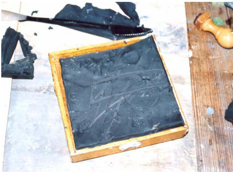
Colocación de un bajorrelieve original en el fondo de la caja para la realización del vaciado y la obtención del molde-matriz. Primer procedimiento en el que se obtenía la matriz directamente, de manera que el bajorrelieve original se pierde.
