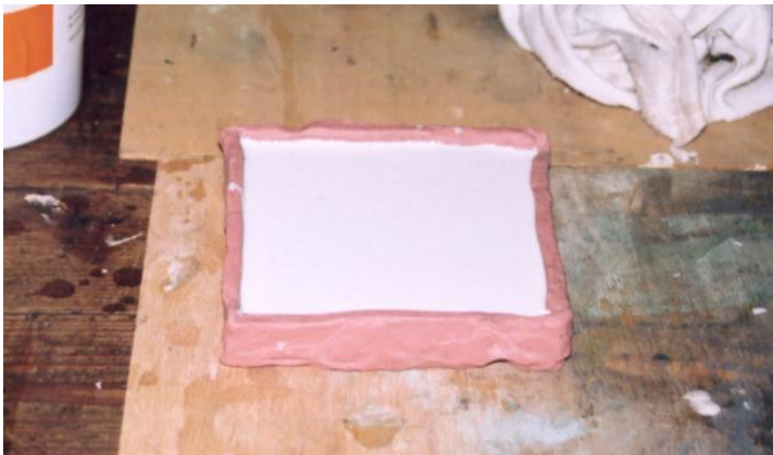
Vaciado de la silicona sobre la matriz en la construcción del contramolde.
