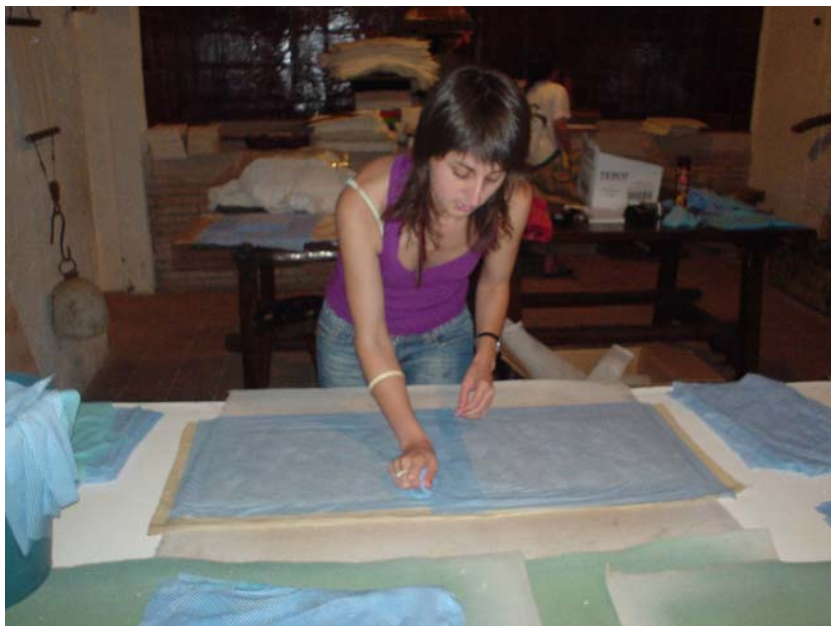
Secado manual de una hoja de papel hecha a medida para un proyecto del curso Relieves y Texturas en Papel . La hoja tiene tres capas de espesor y la pulpa ha sido coloreada de color marfil. La hoja se realizó sobre una tela de algodón de un tamaño mayor al de la hoja, esta tela es la protección para que no se rompa. Sobre la tela se fueron colocando varias veces moldes de pasta hasta conseguir el tamaño y espesor deseado. Tiene un tamaño de 84 x 28cm.
