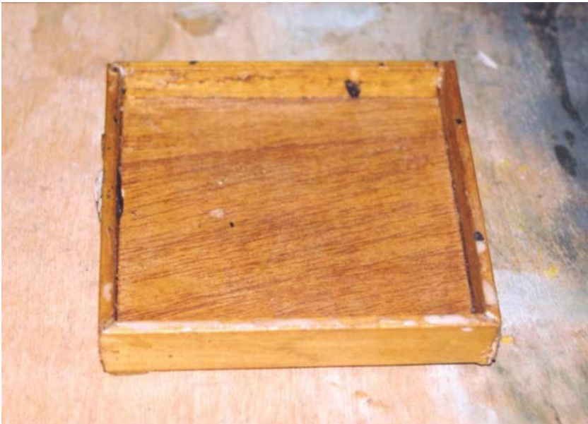
Caja de madera construida para la fabricación de molde-matrices. 13x13x1'5 cm.
