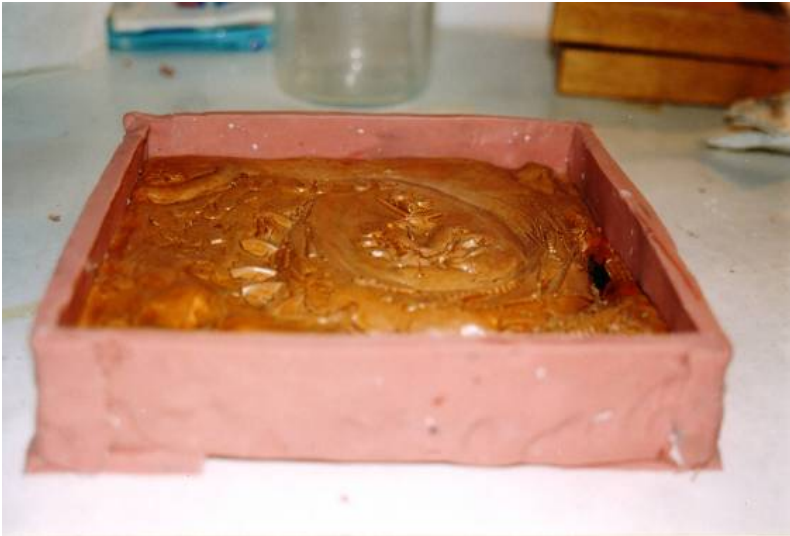
Arriba: Fabricación de un tabique de Plastilina para la contención de la silicona de moldeo.
