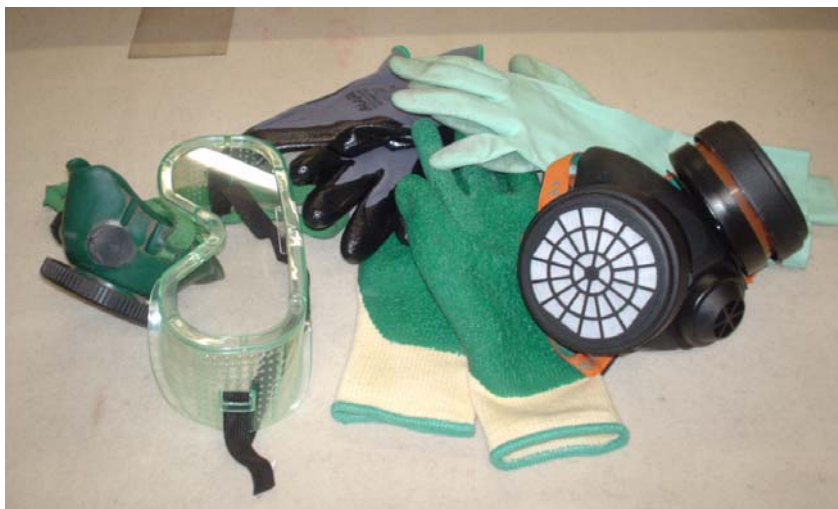
Protecciones para la manipulación y uso de productos peligrosos. En la imagen aparecen diversos tipos de guantes, gafas, mascarilla con filtro de polvo y máscara con filtros antigases.
