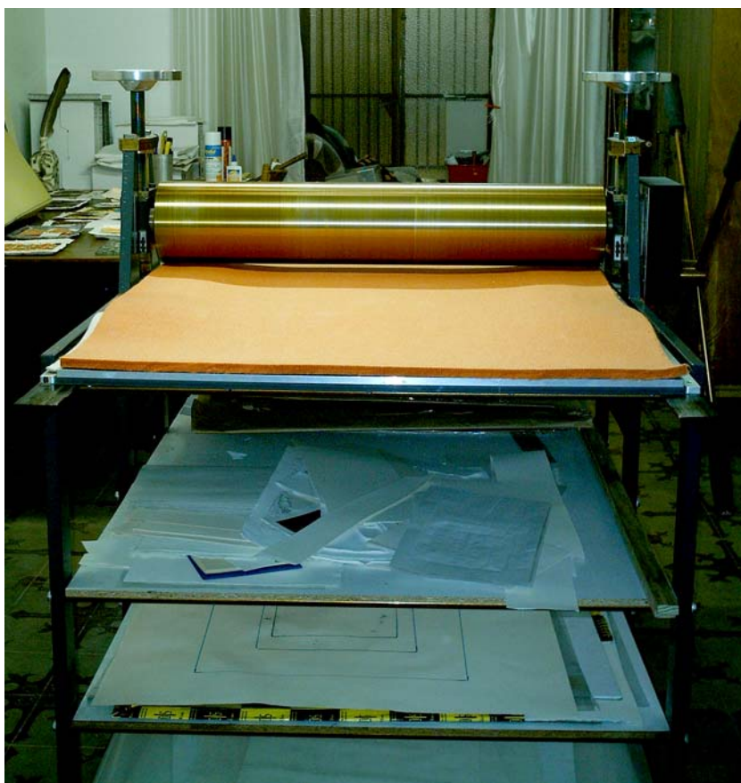
Tórculo de platina de metacrilato. Este tórculo es que se ha utilizado para realizar las estampas de esta tesis.
