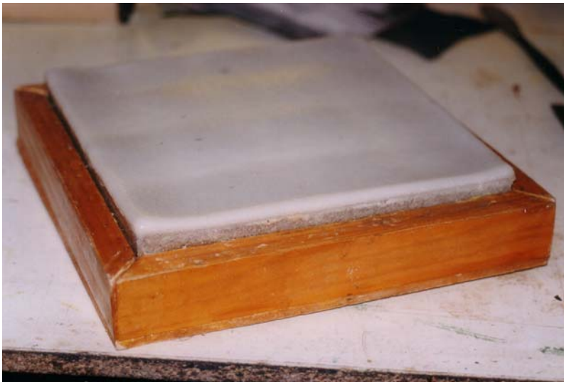
Matriz 3D. Esta matriz esta hecha con una mezcla de resina de poliuretano PC26 y arena de playa. Como se puede apreciar en la foto la mezcla no queda homogénea.
