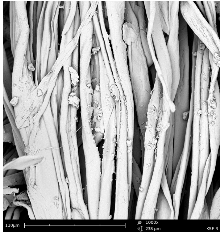
Figura 93. Microfotografía SEM, tejido de algodón tratado con MKSF y resina acrílica.
