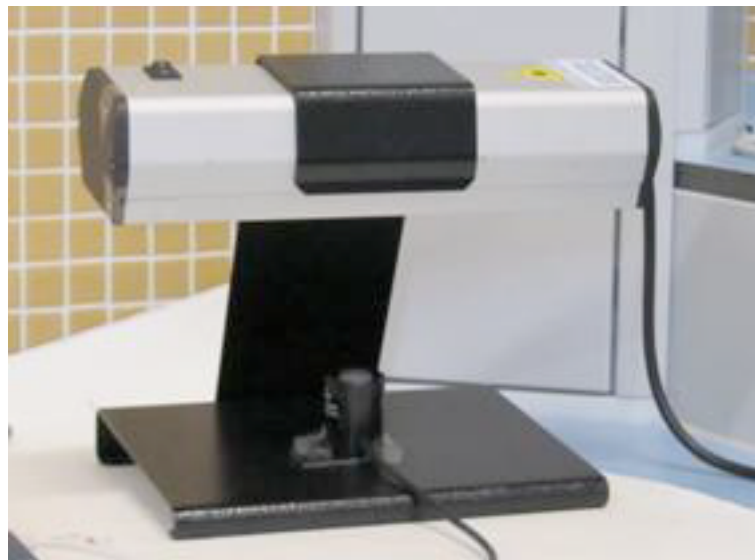
Figura 37. Lámpara utilizada para la medición del UV A y B con su correspondiente detector.
