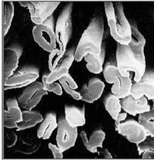
Figura 2. Microfotografía sección transversal fibra de algodón a 1000 aumentos
