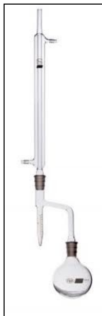
Figura III.2.1.1. Montaje utilizado para la medida de la humedad de las pasas de arándano.
