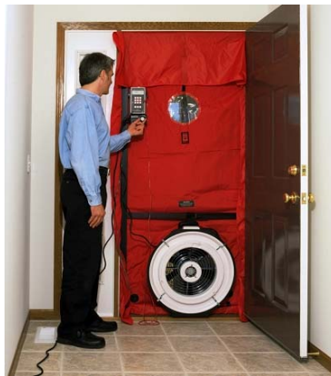
Figura 20. Ensayo Blowerdoor. 2014. Internet.
