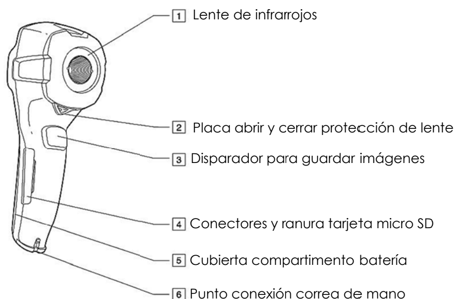
Figura 10: Cámara termográfica Flir i5
