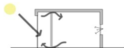
Figura 6: Captación solar indirecta
