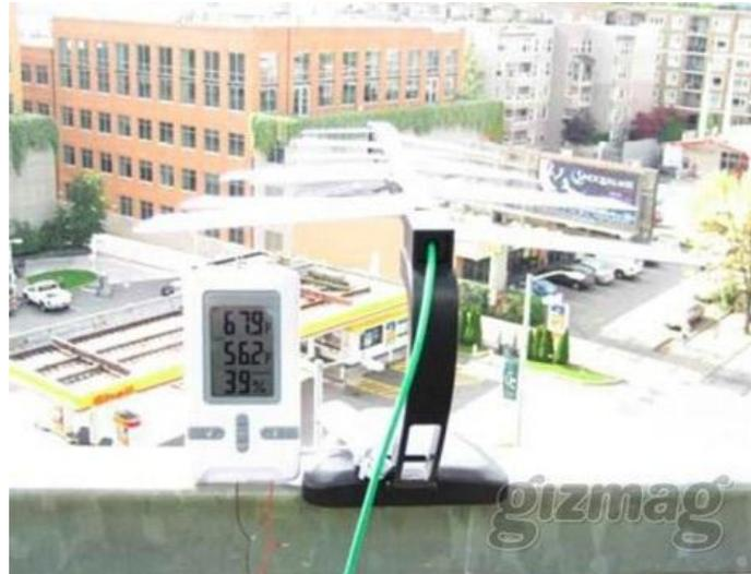
Figura 3. Estación meteorológica con pantalla LCD alimentada por Energy Harvesting. Fuente: <http://www.ison21.es/wp-content/uploads/2009/01/intel-rf-harvesting.jpg>
