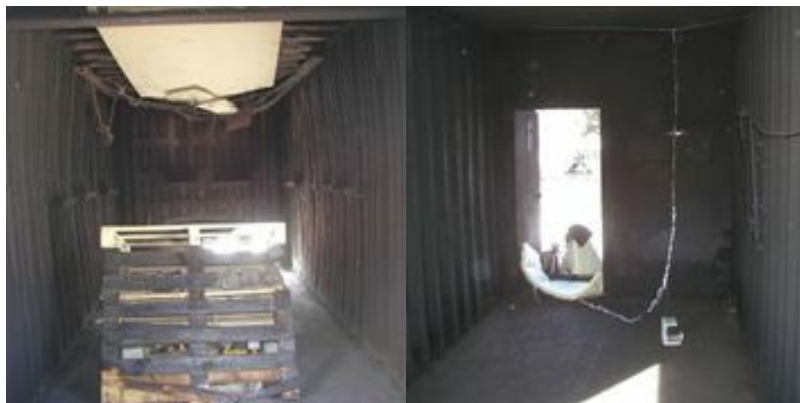
Fig.20 Colocación del combustible y de los termopares en el interior del contenedor
