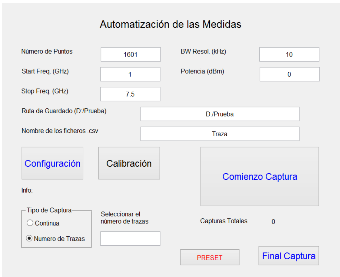
Fig.13 Interfaz gráfica para la configuración del VNA y la captura de medidas
