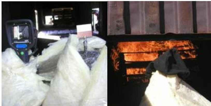
Fig.21 Antenas y cámara empleadas junto a los elementos protectores
