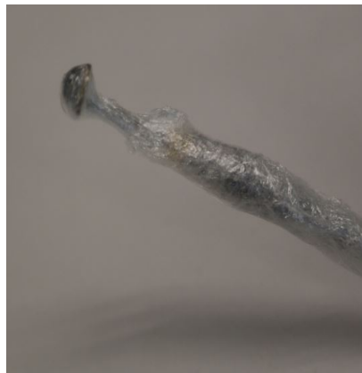
Fig.9 Antena implantable empleada para la caracterización de canal en UWB
