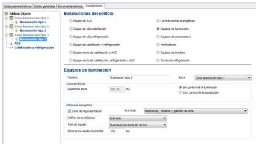
Figura 39. Instalación de datos de iluminación tipo 3
