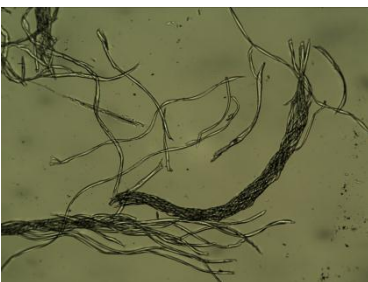
Imagen 22. Análisis de la fibra del lazo (640x)
