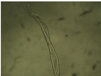
Imagen 17. Análisis de la fibra del cordón (160x)
