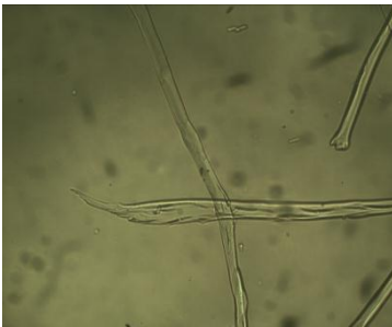
Imagen 21. Análisis de la fibra del lazo (160x)
