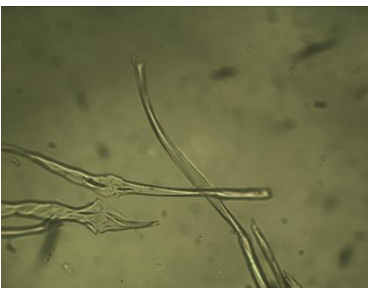
Imagen 23. Análisis de la fibra de la gasa (160x)
