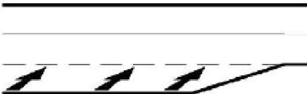
*Figura 6: Detalle sección para carretera 2+1 con eliminación del carril para vehículos lentos. Fuente: Radimsky, M. (2014)*
