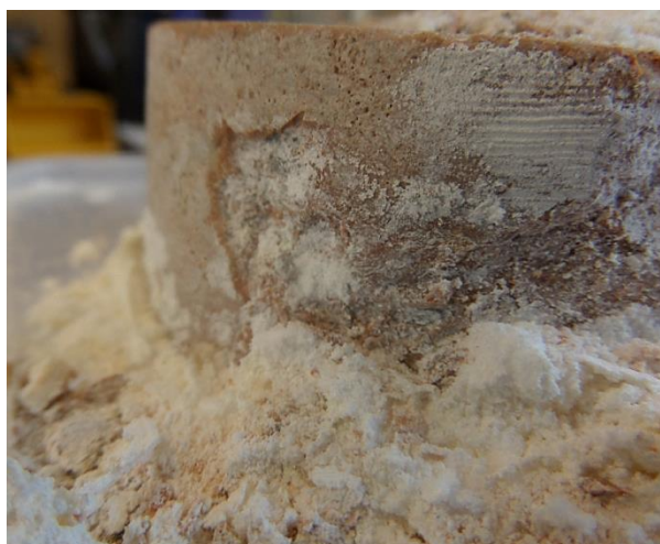
Imagen 263 CICLO ÚNICO. Muestra eclosionada perteneciente al ensayo de un único ciclo de envejecimiento. Se presenta en su estado final. Fuente propia.
