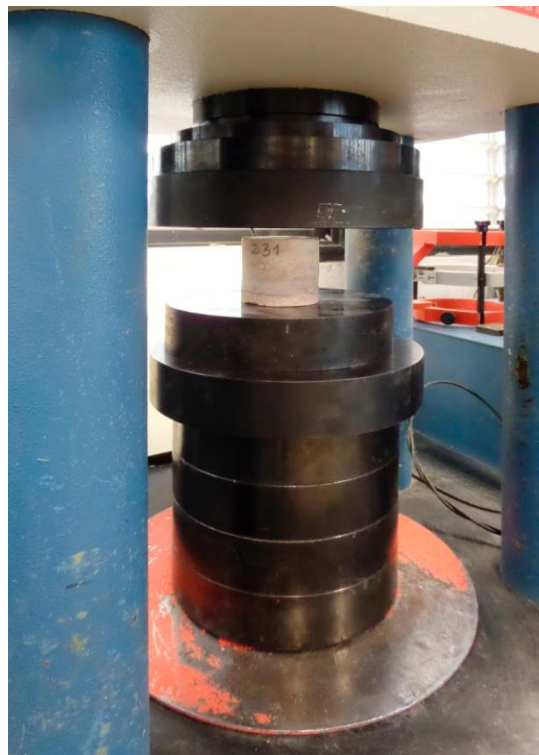
Imagen 123 ENSAYO COMPRESIÓN. Vemos la máquina servo hidráulica actuando sobre la muestra número 231. Fuente propia.
