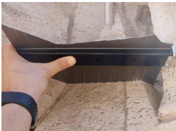
Imagen 223 PEINE ARQUEÓLOGO. Vista del levantamiento del arranque de la caña que vemos en la imagen de la derecha. Fuente propia.
