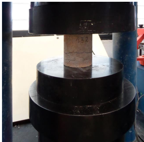
Imagen 125 PROBETAS. Muestra 132 a punto de iniciar el ensayo a compresión. Fuente propia.
