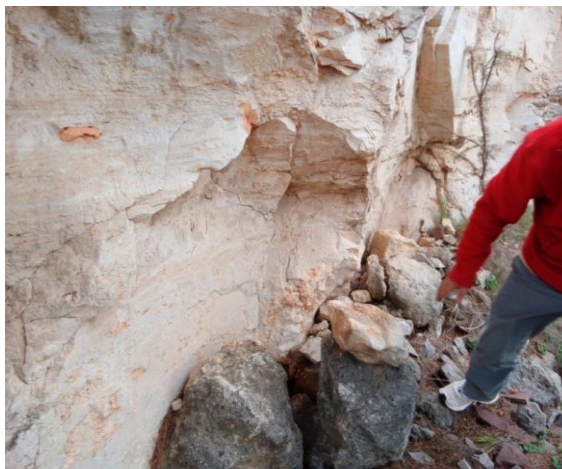
Imagen 114 FRENTE DE CANTERA. CARRETALES. Recogida de piedras para obtención de los testigos. Fuente propia.
