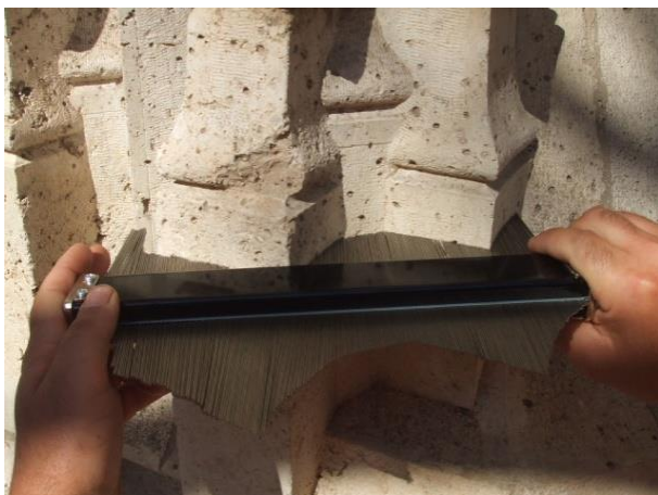
Imagen 218 PEINE ARQUEÓLOGO. Vista del levantamiento del arranque de las cañas que vemos en la imagen de la derecha. Fuente propia.
