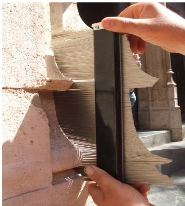
Imagen 4 TOMA DE DATOS CON EL PERFILÓMETRO SOBRE LA JAMBA. Fuente propia
