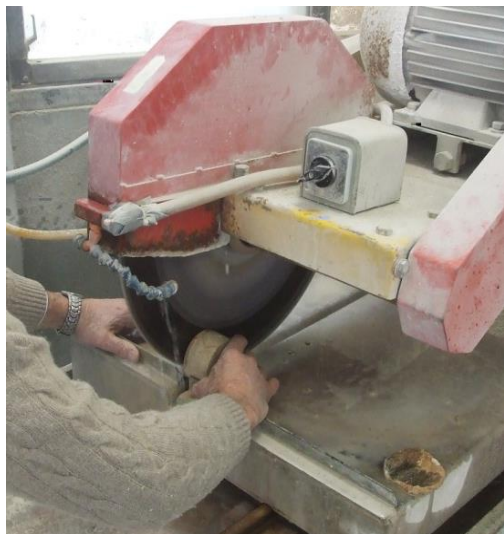
Imagen 122 PROBETAS- Máquina de corte de las probetas en muestras. Fuente propia.
