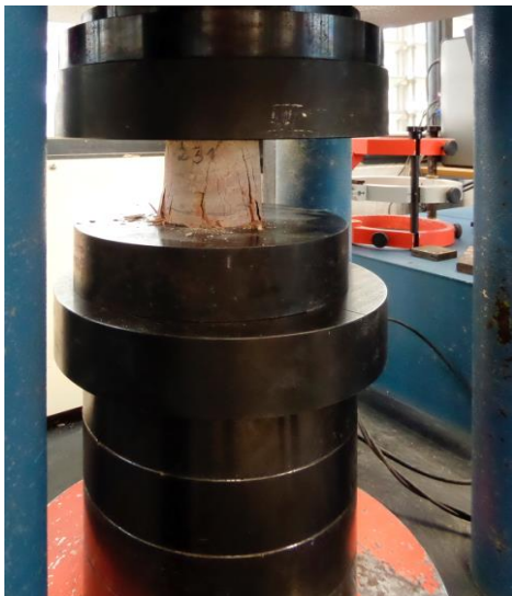
Imagen 127 PROBETAS. Instante en que se rompe la probeta 231. Fuente propia.
