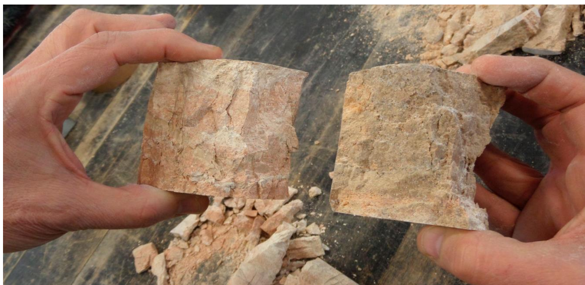
Imágenes 130 PROBETAS. Vemos los resultados de la rotura de las dos muestras de la piedra 1 y 2. Fuente propia.
