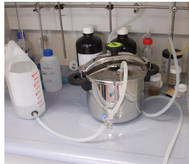
Imagen 133 MUESTRAS. Imagen del recipiente cerrado, los conductos y depósitos para el vaciado mediante una bomba de agua. Fuente propia.
