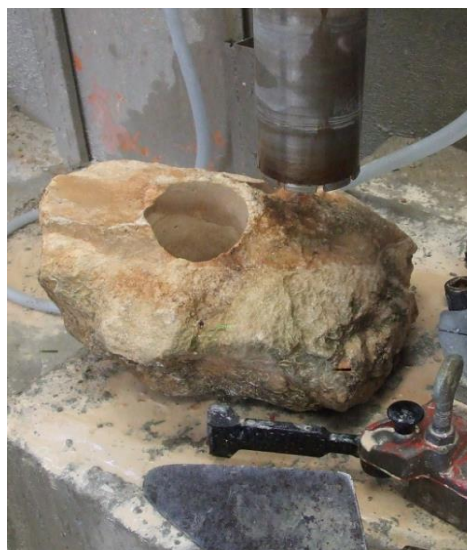
Imagen 117 PROBETAS. Preparado el taladro para iniciar la tercera perforación en la primera piedra. Fuente propia.
