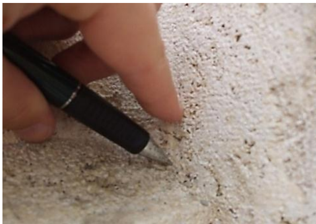
Imagen 253 EL PUNTO EXACTO. Instante en el que se le indica al operador de la Estación total, el punto exacto requerido para la toma de datos en la punta del bolígrafo. Fuente propia.
