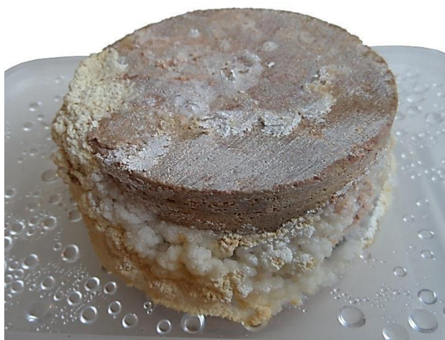
Imágenes 160 MUESTRA 121. Detalle del desprendimiento y efectos ocasionados en la piel de la muestra. Fuentes propias.
