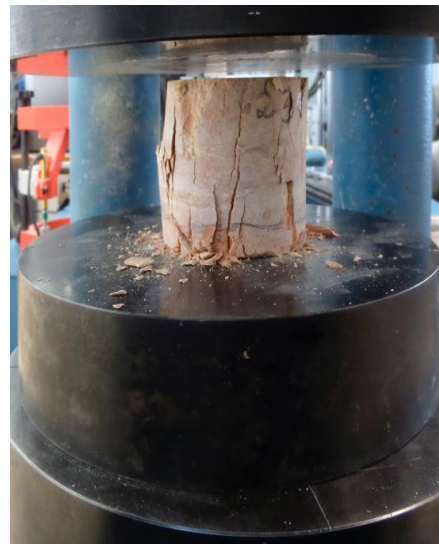
Imagen 129 PROBETAS. La máquina servo hidráulica deja de actuar sobre la probeta 231. Fuente propia.
