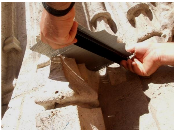
Imagen 221 PEINE ARQUEÓLOGO. Vista del levantamiento del arranque de la caña que vemos en la imagen de la derecha entre los puntos 4 y 5. Fuente propia.
