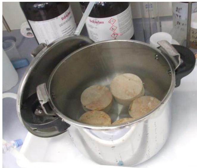
Imagen 134 MUESTRAS. Imagen de las probetas en el recipiente a presión para generar el vacío. Fuente propia.
