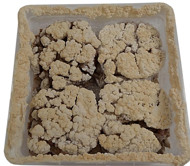
Imagen 155 CUBETA con las cuatro muestras. La solución salina ha desaparecido y las eflorescencias aparecen por todas las partes. Fuente propia tomada el 11 de marzo de 2015
