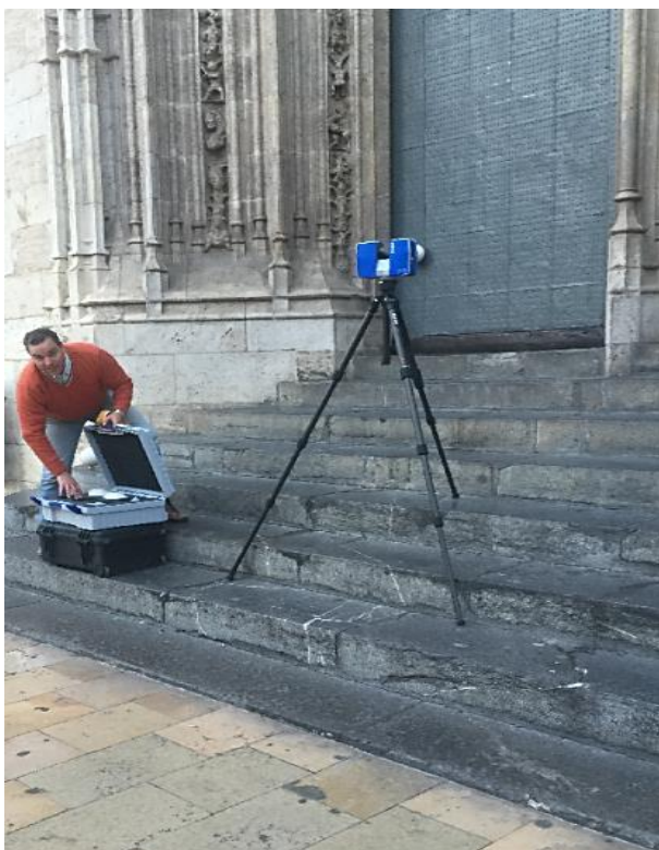
Imagen 186. FARO 3D. En la primera de las 5 estaciones previstas en el levantamiento de la portada. Fuente propia 2015.
