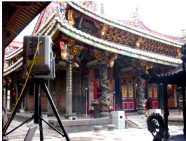
Imagen 180 ESCÁNER trabajando en una de las esquinas exteriores del Templo Pao-an Taiwan Fuente Chen-Yan
