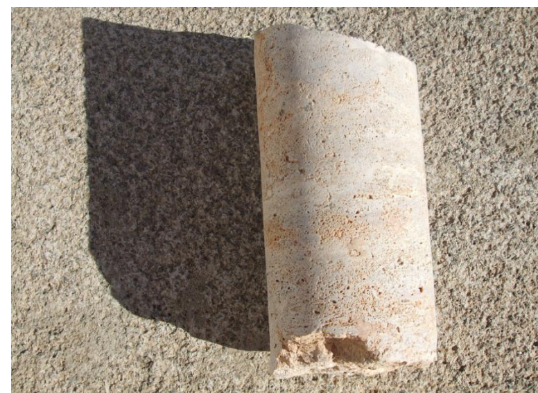
Imagen 119 PROBETAS cilíndricas resultantes de las perforaciones en donde se pueden apreciar las diferentes zonas por el color más o menos rojizo. Fuentes propias.
