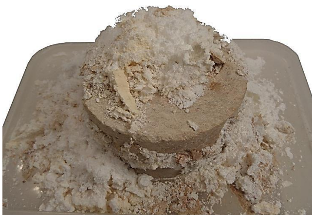
Imàgenes 158 MUESTRA 221. Detalle del desprendimiento y efectos ocasionados en la piel de la muestra. Fuentes propias.
