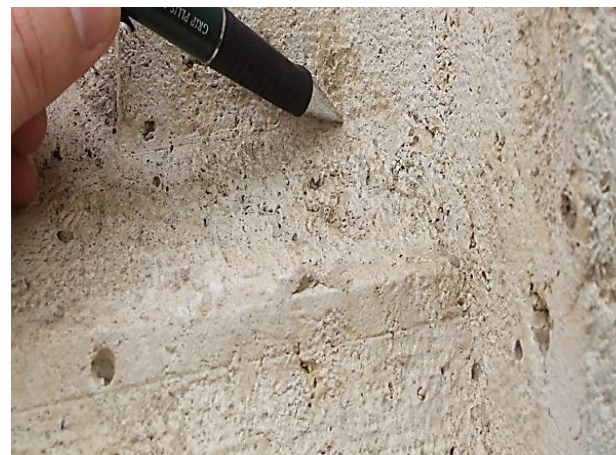
Imagen 252 EL PUNTO EXACTO. Instante en el que se le indica al operador de la Estación total, el punto exacto requerido para la toma de datos en la punta del bolígrafo. Fuente propia.
