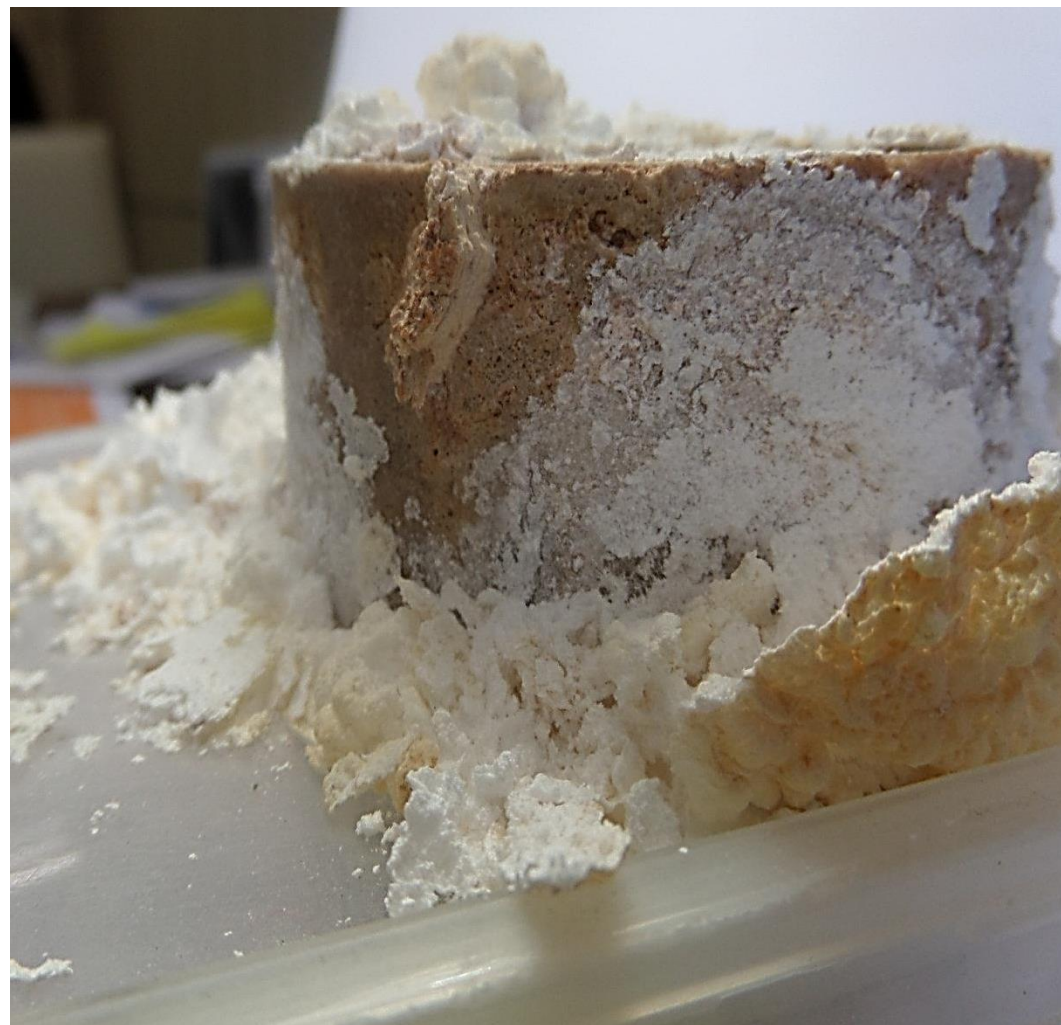
Imágenes 159 MUESTRA 111. Detalle del desprendimiento y efectos ocasionados en la piel de la muestra. Fuentes propias.
