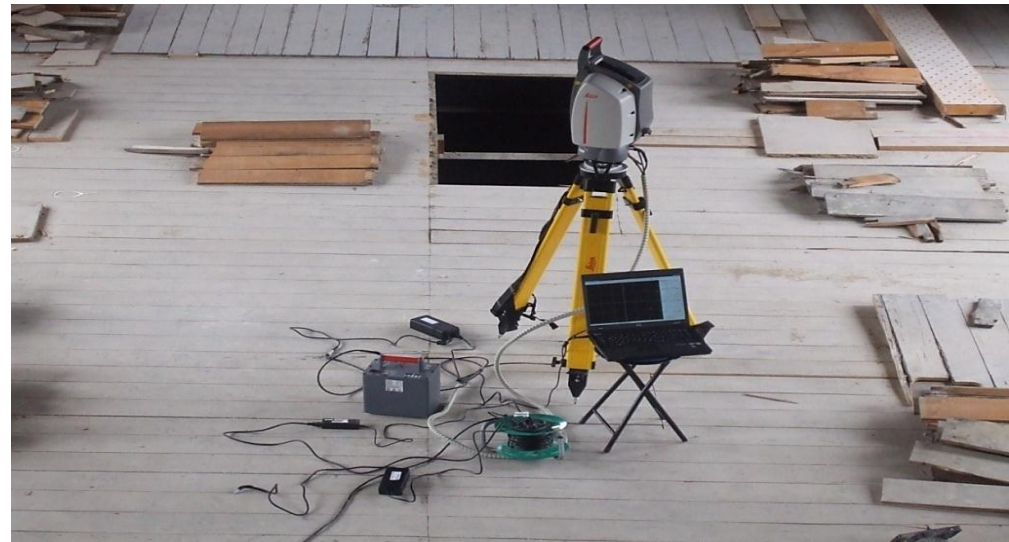
Imagen 182 EL ESCANER LÁSER 3D TRABAJANDO EN LA LONJA DE VALENCIA. Segunda planta del consulado del mar. Fuente propia.
