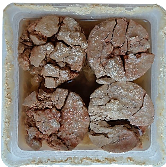
Imagen 153 CUBETA con las cuatro muestras con importantes desprendimientos y muy troceadas. Se ven las precipitaciones sobre las caras superiores y sobre los bordes de la cubeta. Fuente propia tomada el 4 de marzo de 2015
