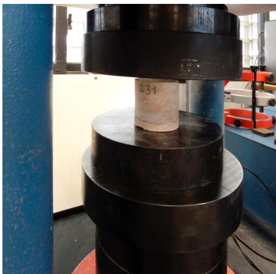
Imagen 126 PROBETAS. Muestra 231 a punto de iniciar el ensayo a compresión. Fuente propia.
