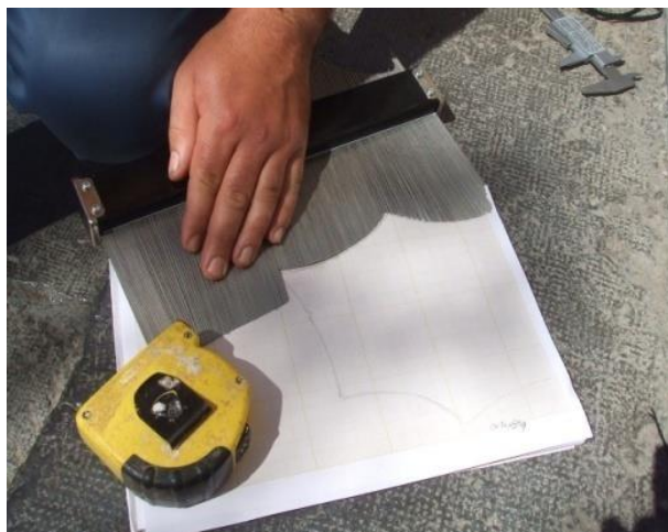
Imagen 5 RESULTADOS DEL LEVANTAMIENTO CON EL PERFILÓMETRO Fuente propia
