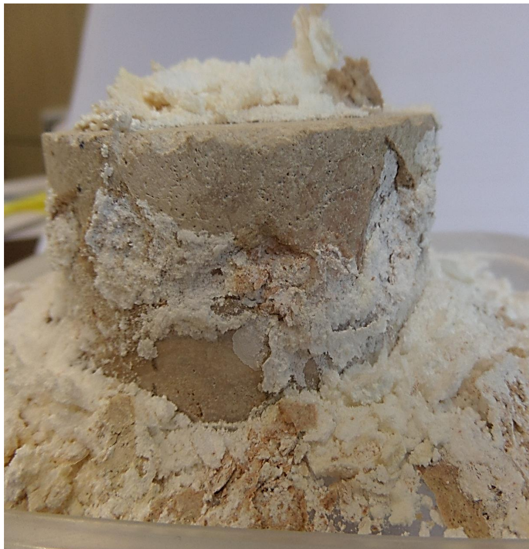
Imàgenes 158 MUESTRA 221. Detalle del desprendimiento y efectos ocasionados en la piel de la muestra. Fuentes propias.
