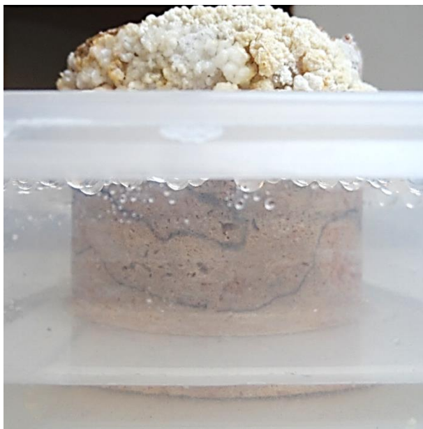
Imagen 260 MUESTRA . Se pueden apreciar las marcas dibujadas sobre la muestra, del nivel que el agua alcanzó por capilaridad, sumergidas 10 mm a los 30 y a los 90 minutos. Fuente propia.
