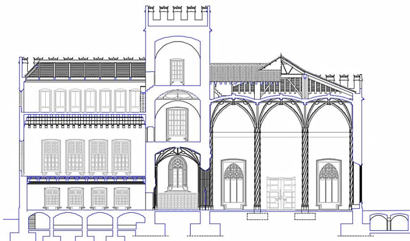
Imagen 33 SECCIÓN LONGITUDINAL paralela a la fachada principal, se observa el pabellón del mar, la torre y la salón columnario. Fuente del plano D. Jorge Girbés Pérez. Imagen propia
