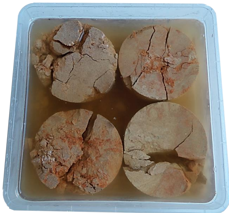
Imagen 151 CUBETA con las cuatro muestras con importantes grietas y desprendimientos. Fuente propia tomada el 21 de febrero de 2015.
