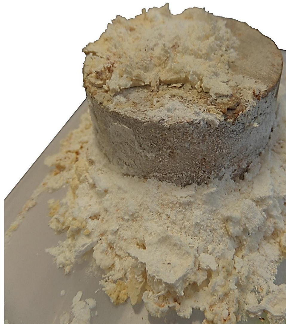
Imágenes 160 MUESTRA 121. Detalle del desprendimiento y efectos ocasionados en la piel de la muestra. Fuentes propias.
