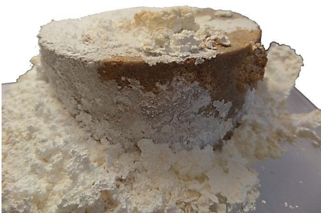
Imágenes 159 MUESTRA 111. Detalle del desprendimiento y efectos ocasionados en la piel de la muestra. Fuentes propias.
