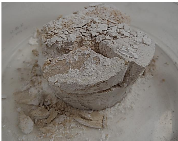
Imagen 262 CICLOS MÚLTIPLES. Muestra eclosionada perteneciente al ensayo de los ciclos múltiples en su fase final, sin solución salina. Fuente propia.
