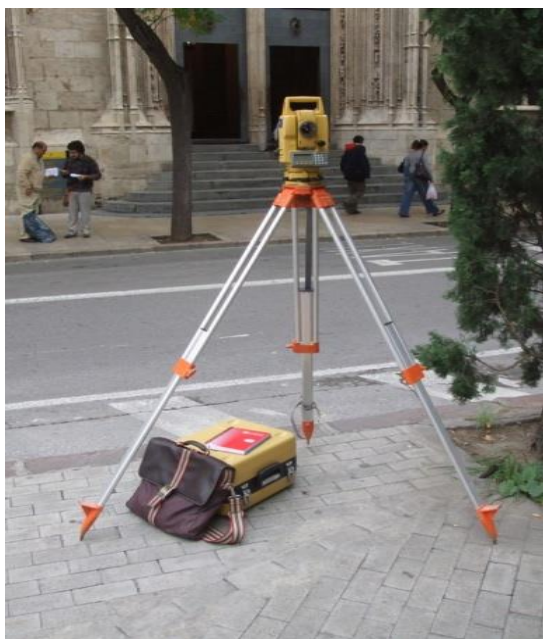
Imagen 268 ESTACIÓN TOTAL TOPCON trabajando en el levantamiento de la portada principal de la Lonja de Valencia. Fuente propia.
