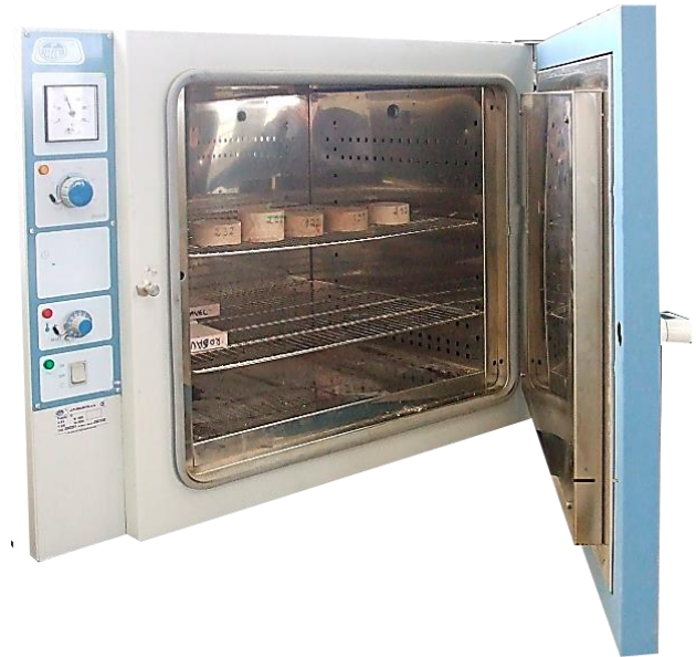
Imagen 148 HORNO utilizado en el secado de las muestras a temperatura 100° durante 16 horas en cada ciclo. Fuente propia.
