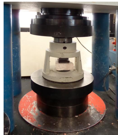
Imagen 124 PROBETAS. Muestra de mármol a punto de iniciar el ensayo a compresión. Fuente propia.
