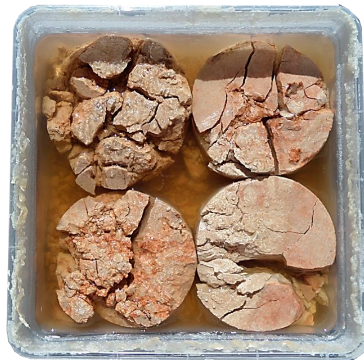
Imagen 150 CUBETA con las cuatro muestras con importantes desprendimientos. Se empiezan a ver las primeras precipitaciones sobre las caras superiores expuestas al aire. Fuente propia tomada el 2 de marzo de 2015.
