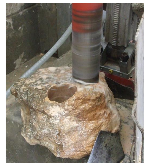
Imagen 116 PROBETAS. Perforación de la segunda de las piedras. Se aprecia el agua de refrigeración utilizada en el corte. Fuente propia.
