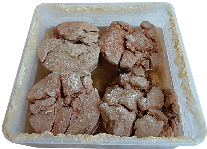
Imagen 154 CUBETA con las cuatro muestras. El nivel de la solución salina sigue descendiendo. Y la disgregación de las muestras parece ya definitivo. Fuente propia tomada el 9 de marzo de 2015
