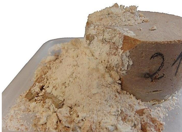
Imágenes 157 MUESTRA 211. Detalle del desprendimiento y efectos ocasionados en la piel de la muestra. Fuentes propias.
