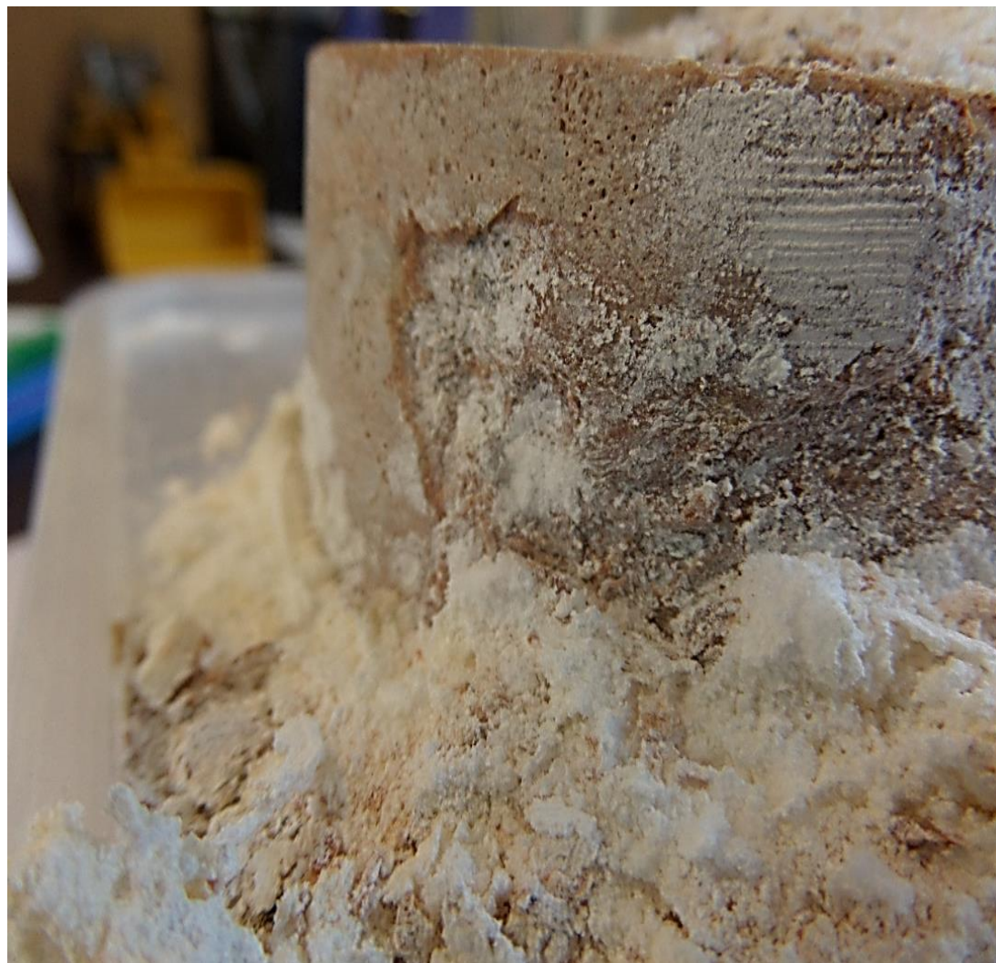
Imágenes 157 MUESTRA 211. Detalle del desprendimiento y efectos ocasionados en la piel de la muestra. Fuentes propias.
