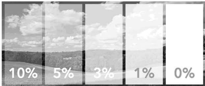
7.10. 1 Variabilidad de los factores de apertura del Screen y su influencia en la transparencia del tejido
