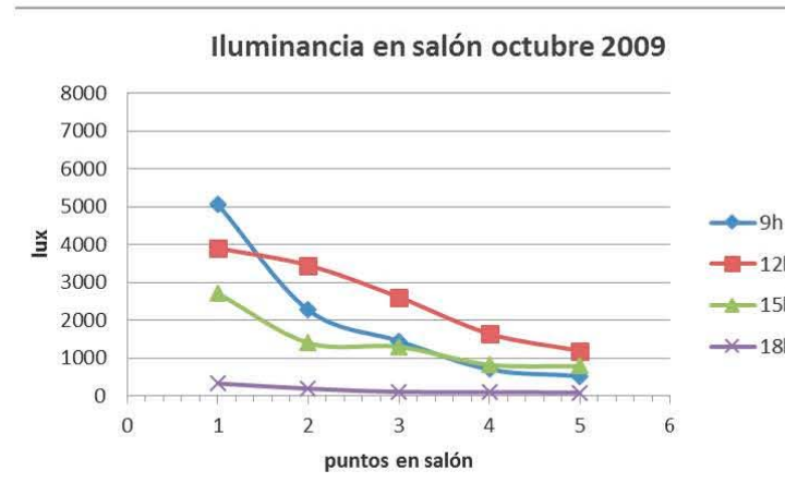
Gráfica 9.2.5. 1 Gráfica de comparación de iluminancias en octubre en el salón de la Casa ELN, sobre una recta imaginaria.
