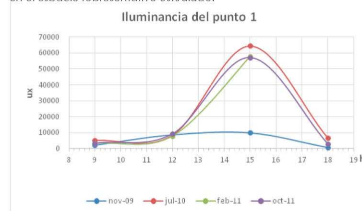
9.0. 810 Gráfica de comparación de iluminancias en un punto de la recta perpendicular a la envolvente, entre las diferentes mediciones en cada mes estudiado.
