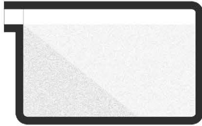
7.1.1. 13 Esquema de lucernario reflector cañón lineal rasante horizontal.
