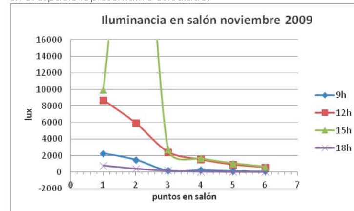
9.0. 9 Gráfica adoptada para el estudio de iluminancias en el mes de noviembre, sobre una recta imaginaria perpendicular a la envolvente, en el espacio representativo estudiado.
