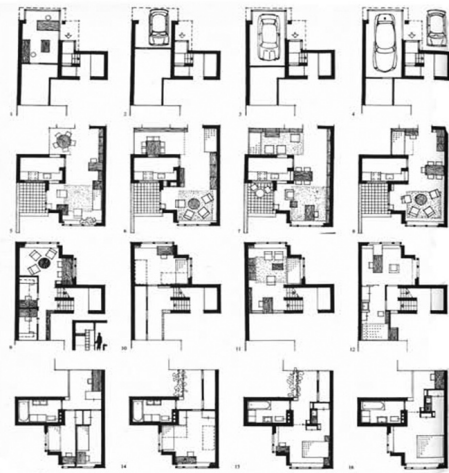
Fig.3.11. Viviendas Diagoon, Herman Hertzberger, 1967-1970. En estas viviendas los únicos espacios con uso específico eran los de cocina y baños, en el resto el uso se lo podía asignar el usuario según sus preferencias.
