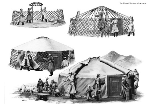
Fig.2.1. El Ger o Yurta es una construcción manufacturada de Asia central, usada por pueblos como los Mongoles desde la Edad Media. Consiste en una estructura geodésica que puede ser desmontada para su traslado y es lo suficientemente resistente como para ser desplazada distancias cortas.
