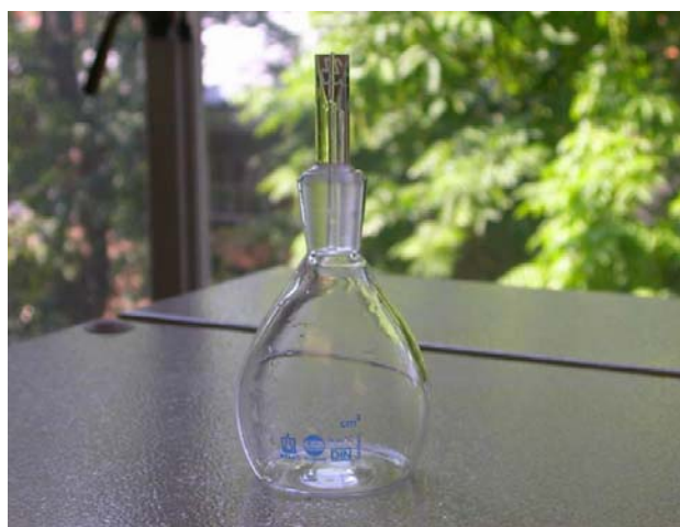
Figura 3.13. Picnómetro utilizado para la determinación experimental de la densidad del fango seco (Nopens, 2005a).
