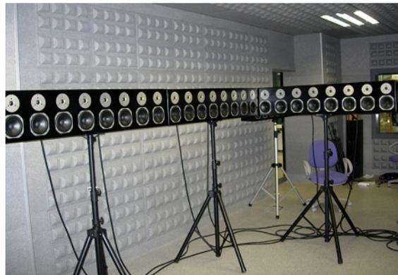
*Figura 4.16.* Prototipo de array de 96 canales dinámicos.
