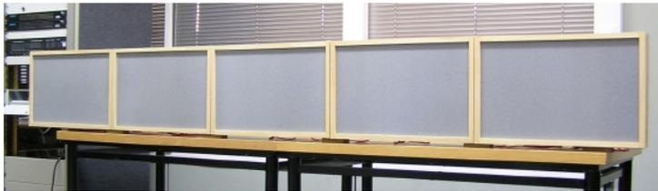
*Figura 4.20.* Prototipo de array con 5 paneles de altavoces planos.
