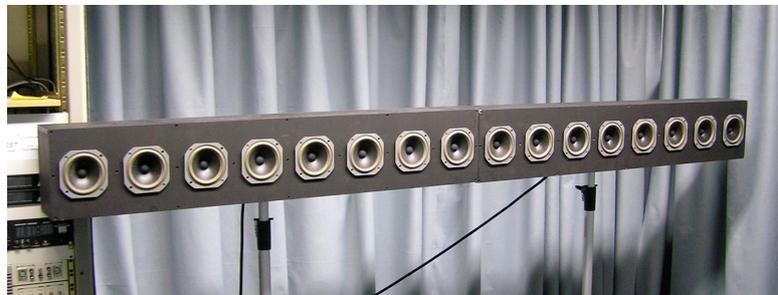
*Figura 4.19.* Prototipo de array de 24 canales dinámicos.
