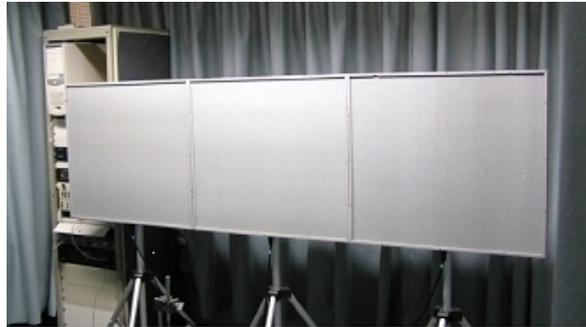
*Figura 4.21.* Prototipo de array con 3 paneles de altavoces planos.
