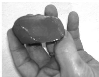
Fig.1.7: Superficie de corte de una arcilla.
