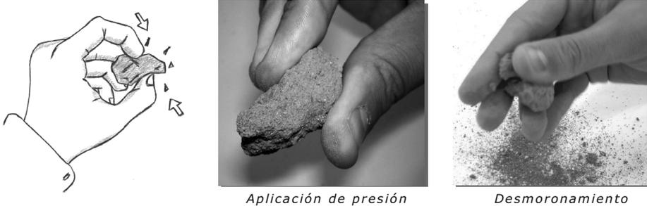
*Fig.1.9: Ejemplo de determinación de resistencia en seco.*
