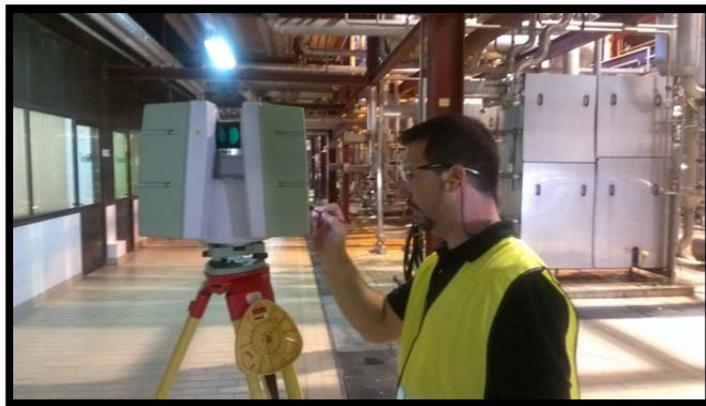
Figura 22. Configurando tomas en el interior de la instalación
