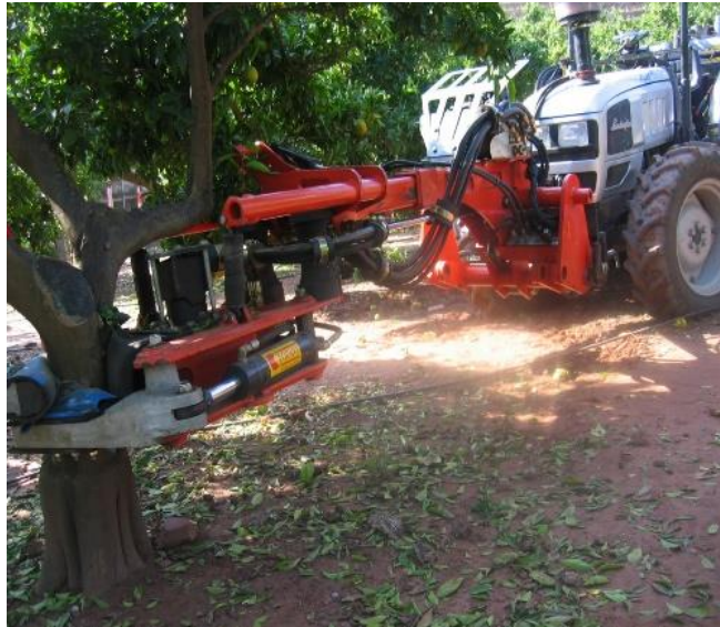
Figura 14.- Vibrador de tronco y tractor Lamborghini 990Fplus
