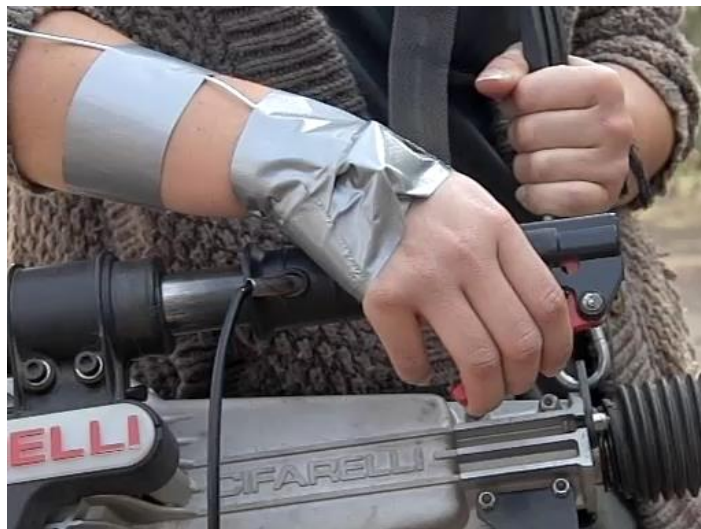
Figura 16.- Fijación del acelerómetro al operario
