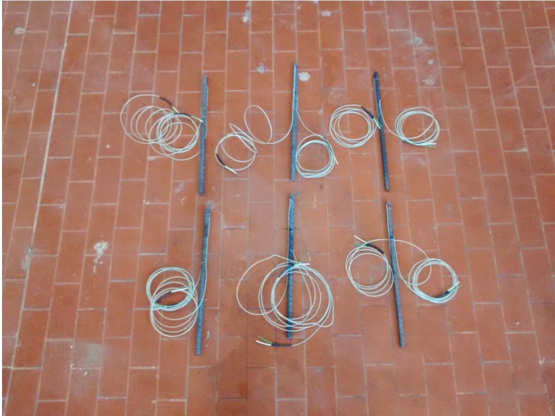
Imagen 32.- Barras corrugadas con los termopares enganchadas.
