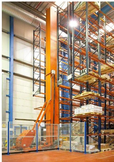
*Figura 3: Transelevador trilateral automático, marca Mecalux®*
