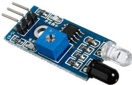
Figura 22: Sensor infrarrojo reflexion modelo 1
