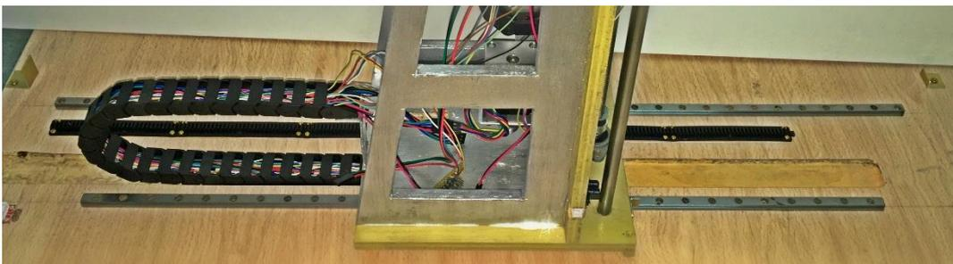
*Figura 13: Eje x. Guías lineales y cremallera*
