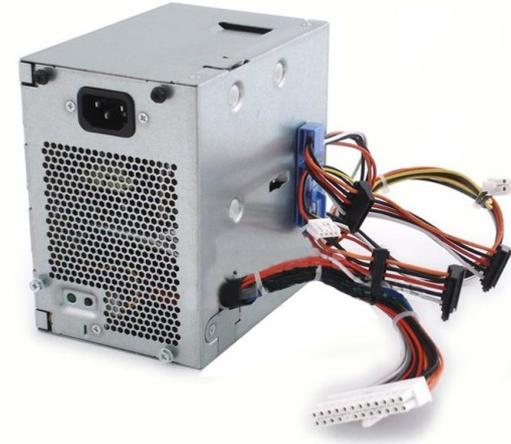
*Figura 31: Fuente de Alimentación ATX*
