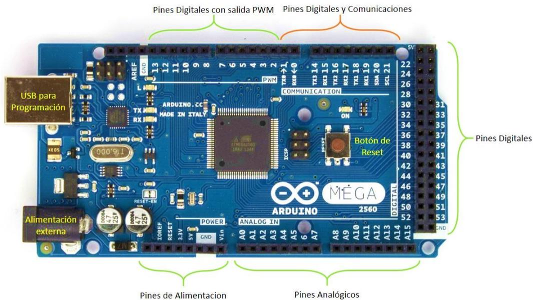
Figura 19: Estructura de un *Arduino*® *Mega* 2560
