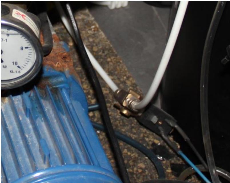
Aquí , se puede apreciar la electroválvula por un lado conectada al filtro de osmosis y por el otro a su rele.
