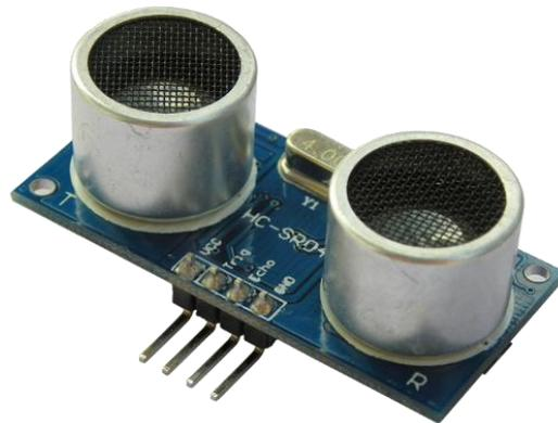
El sensor de ultrasonidos se enmarca dentro de los sensores para medir distancias o superar obstáculos, entre otras posibles funciones.
