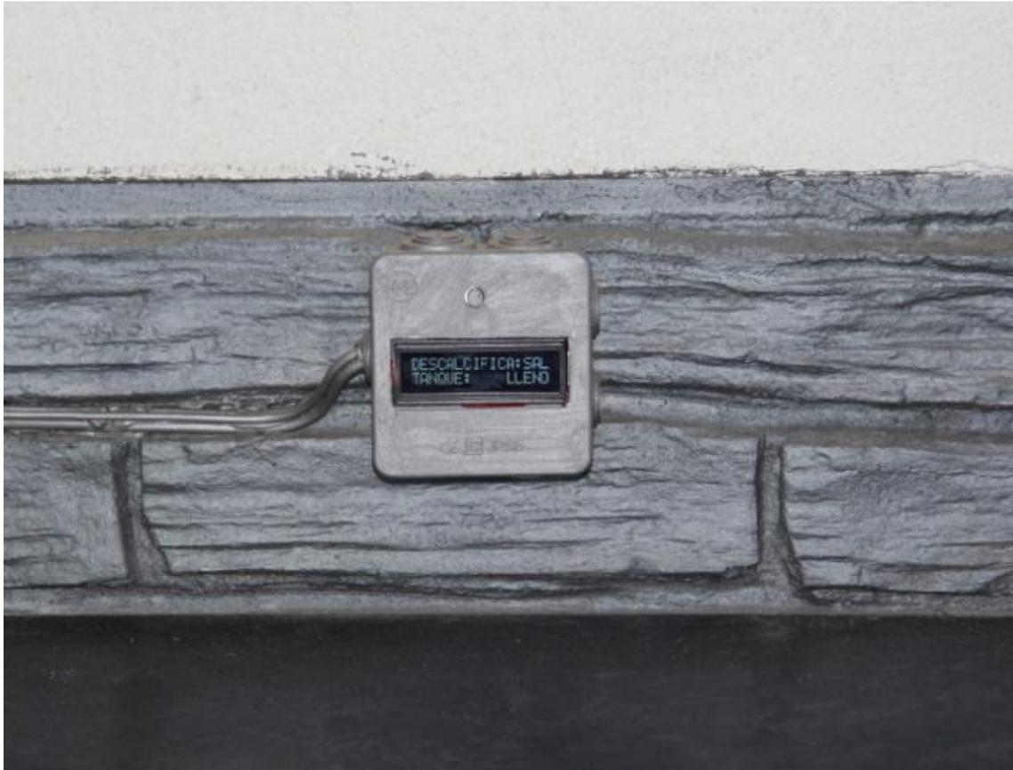
Aquí tenemos montada la caja que nos hará de display, se ha colocado un pulsador el cual está conectado al arduino y cuando se pulse , este lo leerá y nos activara la bomba de agua que tenemos introducida dentro del tanque , durante 1,45 min que es el tiempo que tarda en llenarse una garrafa de agua de 25l con el caudal que nos da esta pequeña bomba.
