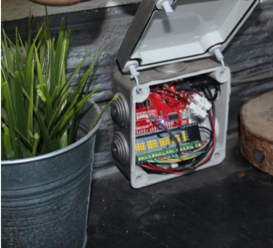
En esta última imagen, vemos la arquitectura centralizada de esta parte del proyecto, donde se aprecia el arduino conectado con todos los elementos, sensores, relés, pantalla.
