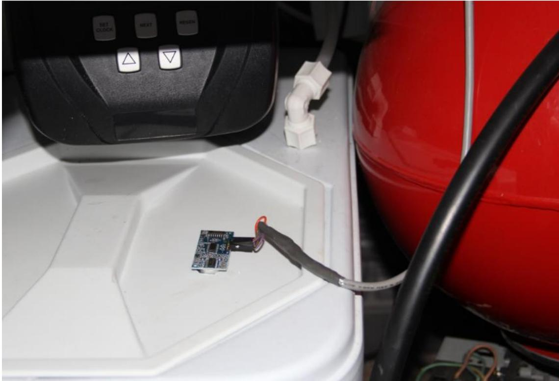
Aquí tendríamos el sensor de ultrasonidos conectado a la descalcificadora, el cual nos manda la información al arduino midiendo la distancia desde donde se encuentra el y donde está la sal , cuando esta distancia supera los 40 cm , el arduino nos imprimirá en la pantalla que nos falta sal, como se aprecia en la captura anterior de la caja de la lcd.
