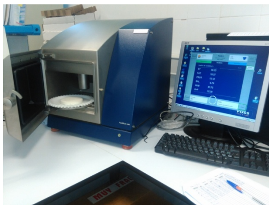
Figura 12. FoodScan (Foss) utilizado en el análisis de la composición del queso
