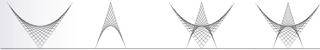
1. Generatrices en una sola dirección. Paraboloides hiperbólico de bordes rectos.
