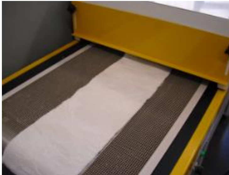
Figura 31. Secadero de infrarrojos horizontal
