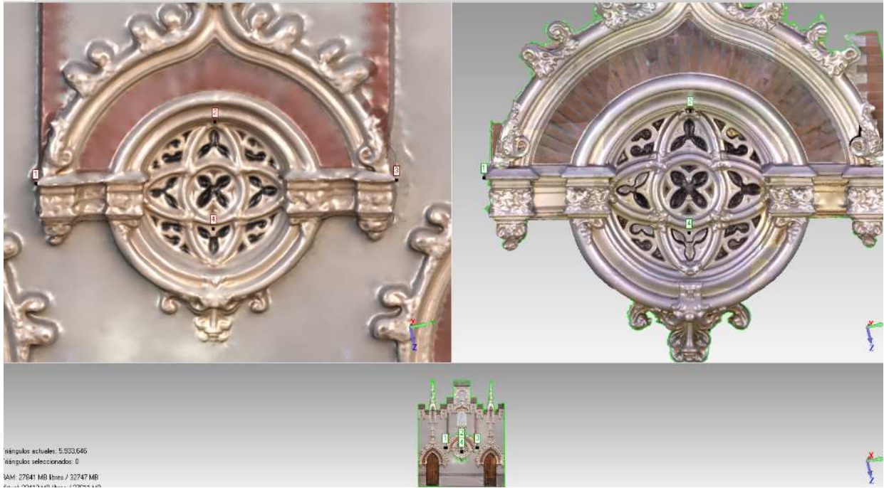
Ilustración 59.- Alineación manual entre el rosetón y la fachada. (Fuente: Fachada.wrp) .
