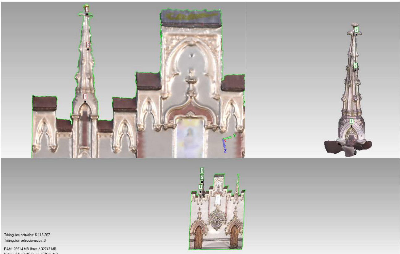
Ilustración 64.- Alineación entre el pináculo izquierdo de la fachada y el pináculo con detalle. (Fuente: Fachada.wrp).
