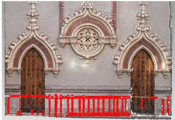
Ilustración 53. -Eliminación de los puntos que definen las vallas (Fuente: Fachada.wrp).
