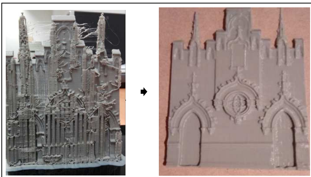
Ilustración 77.- Resultado de la Impresión de la fachada (Fuente: IMG_20170630_104724.jpg e IMG_20170630_114310.jpg).
