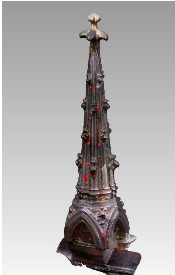
Ilustración 32.- Fusión entre modelos y reparación de la malla. (Fuente: Pinaculo.wrp).
