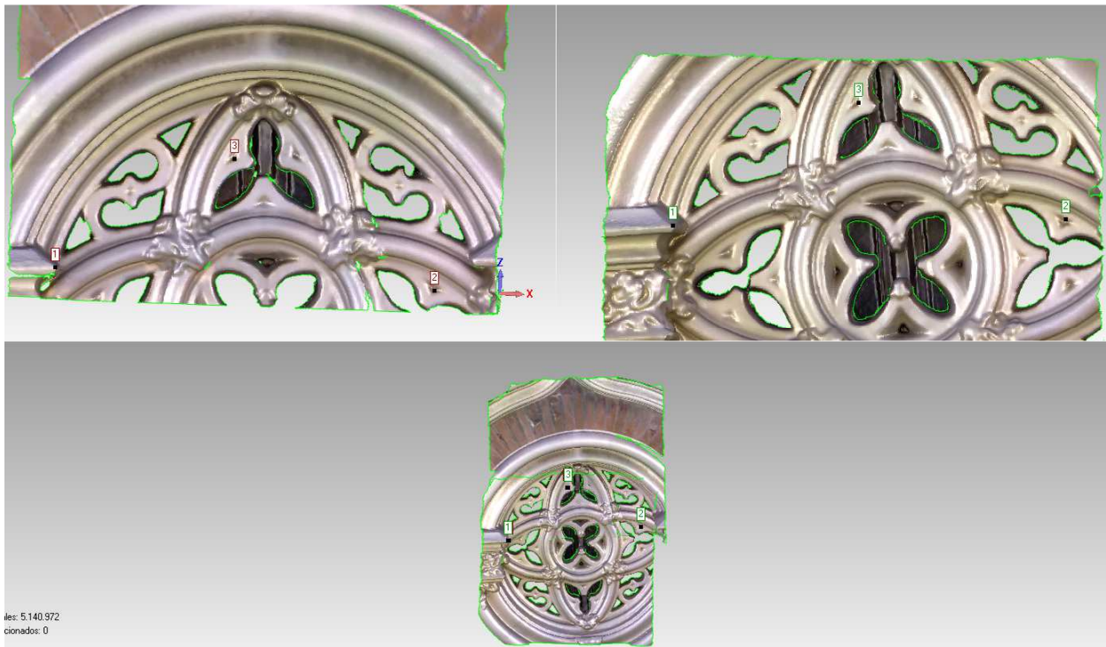
Ilustración 41. -Alineación entre dos escaneos del rosetón. (Fuente: Roseton.wrp).
