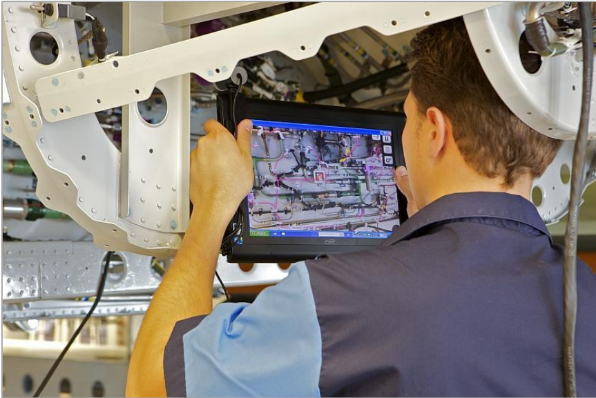
Imagen 26. Sistema MOON de ayuda al montaje de instalaciones mediante RA. Fuente: Soluciones avanzadas para la creación de IT de montaje aeronáutico mediante herramientas PLM (2012).
