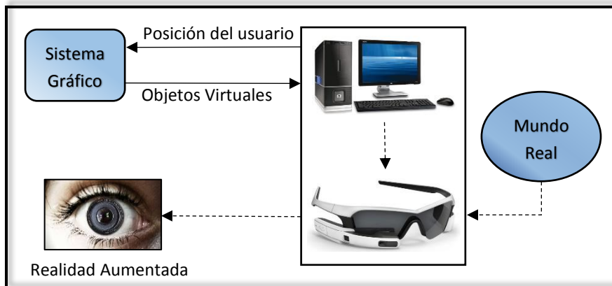
Ilustración 10. Dispositivos Optical See-Through. Fuente: Elaboración propia basada en Azuma (1997).
