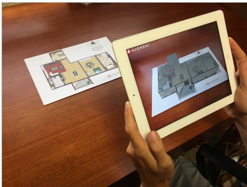
Imagen 63. Visualización en RA de vivienda en 3D sobre plano. Fuente: Elaboración propia.
