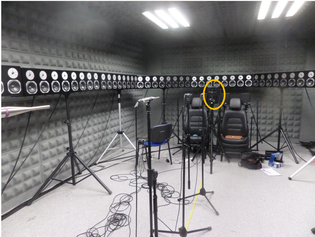
Figura 15. Disposición de los micrófonos y altavoz (amarillo)
