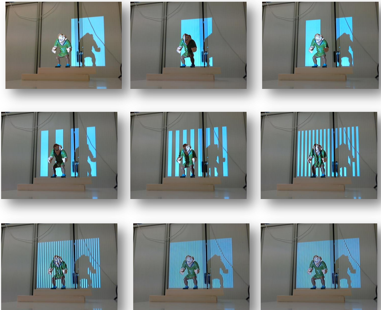
Figura 1 – Colección de imágenes usando luz estructurada aplicando código gray.
