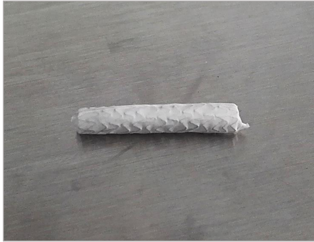
Figura 21: Stent recubierto una vez se ha producido la retirada del balón.
