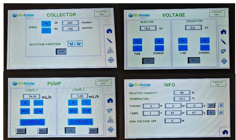
Figura 23: Configuración de las variables de operación en panel táctil de Fluidnateck LE-500.
