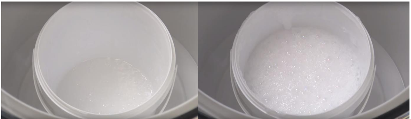
Adrián Pérez-Montejano J. 2017. "Hervido" de la silicona al hacer el vacío.
