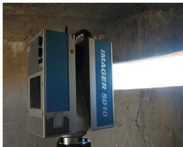
Figura 12. Láser-escáner IMAGER 5010
