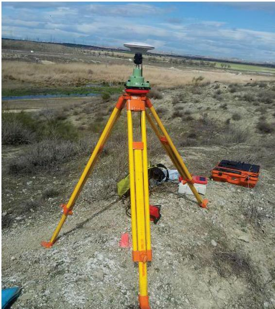
Figura 4: Receptor GPS Leica 500 observando el vértice 9001 de la red con el método relativo estático rápido.
