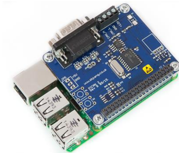
Ilustración 69: Raspberry junto con la Shield PiCAN 2
