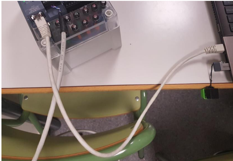
Ilustración 81: Conexión física entre el automático y el portátil
