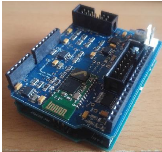
Figura 51. Kit de evaluación del Arduino Uno junto con el Arduino Shield de diseño propio con todos los componentes soldados apilado al kit de evaluación del mismo.
