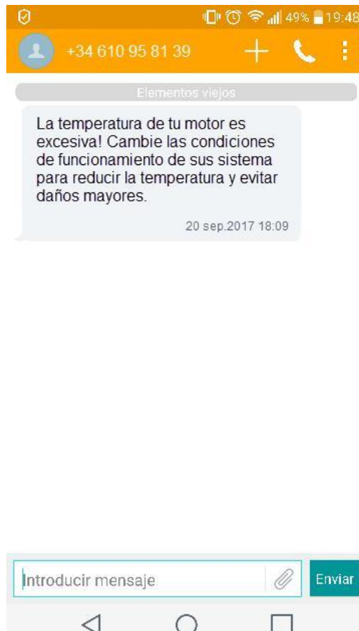
Figura 75. Mensaje SMS de alerta ante un exceso de temperatura.
