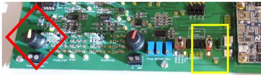
Figura 10. Interruptor para la habilitación de disparos (recuadro amarillo) y el potenciómetro para variar la velocidad de giro del motor (recuadro rojo). 8
