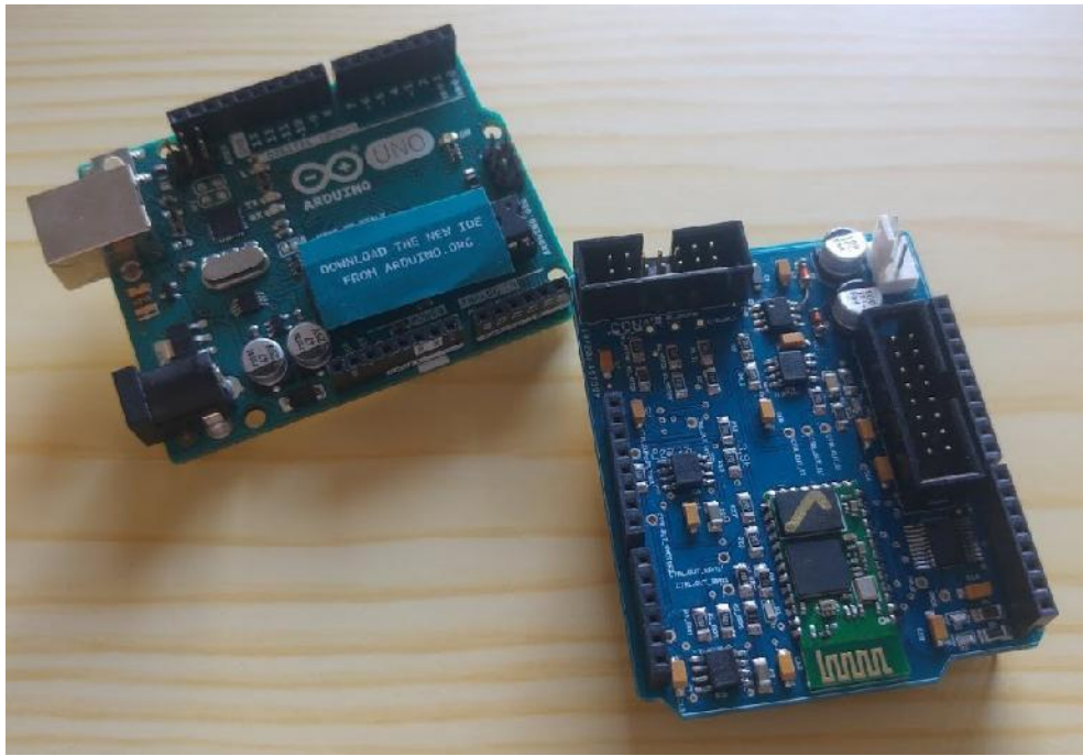
Figura 50. Kit de evaluación del Arduino Uno (izquierda) junto con el Arduino Shield de diseño propio (derecha) con todos los componentes soldados.
