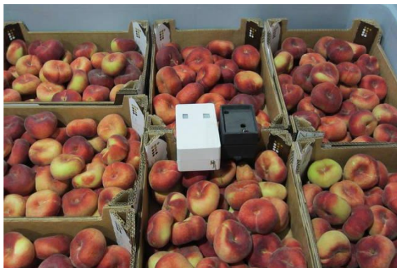
Ilustración 8. Sensores para medir temperatura, humedad y contacto en packaging. Fuente: Web
