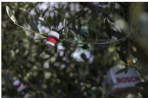
Ilustración 20. Sensores MEMS para medir estrés hídrico en las hojas. Fuente: Web
