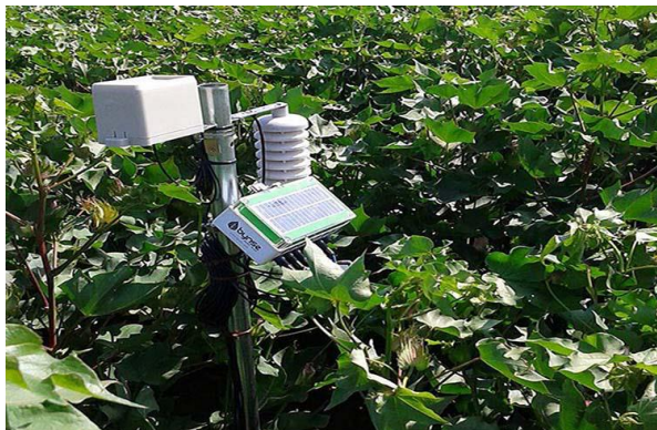
Ilustración 12. Sensores remotos para control de plagas y enfermedades. Fuente: Web
