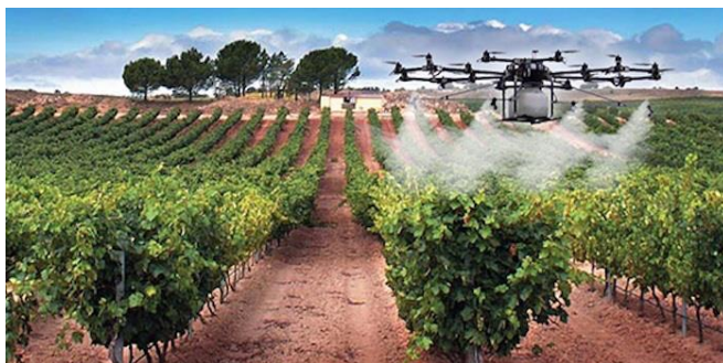
Ilustración 13. Dron para la aplicación de fertilizantes y pesticidas. Fuente: Web
