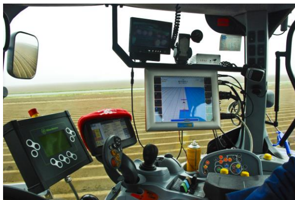
Ilustración 17. Sensores y GPS en maquinaria para medir rendimiento del suelo. Fuente: Web
