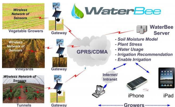
Ilustración 19. Redes WSN para sistemas de riego inteligente. Fuente: Web
