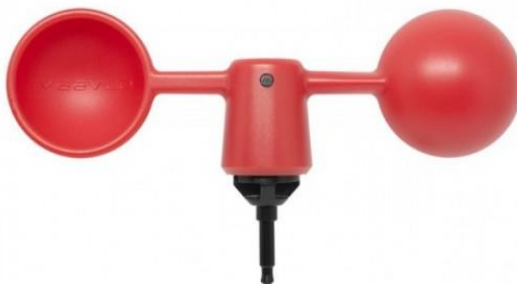
Ilustración 4. Sensor para medir la velocidad del viento. Fuente: Web
