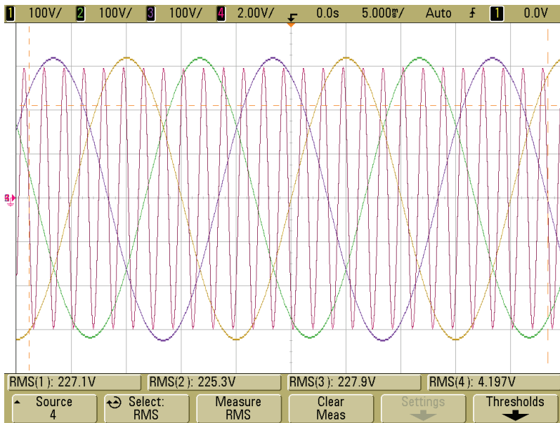
Figura 5-80. Sistema trifásico de 50Hz equilibrado y sin distorsión junto con la salida del regulador PL (magenta) cuando la entrada al mismo es de 550Hz.
