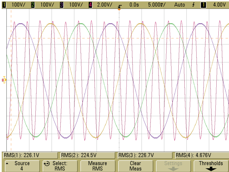
Figura 5-69. Sistema trifásico equilibrado y sin distorsión junto con la salida del regulador PL (magenta) cuando la entrada al mismo es de 350Hz.
