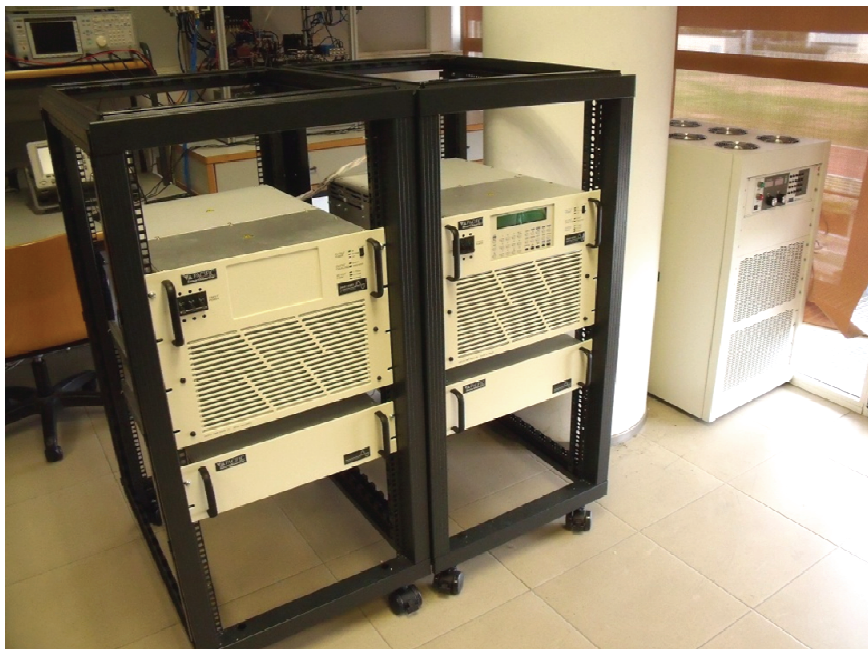
Figura AI-2. Fuente de alimentación AC (izquierda) y DC (derecha).
