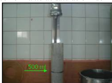
Fotografía 1. Ensayo de fluidez a través del Cono de Marsh
